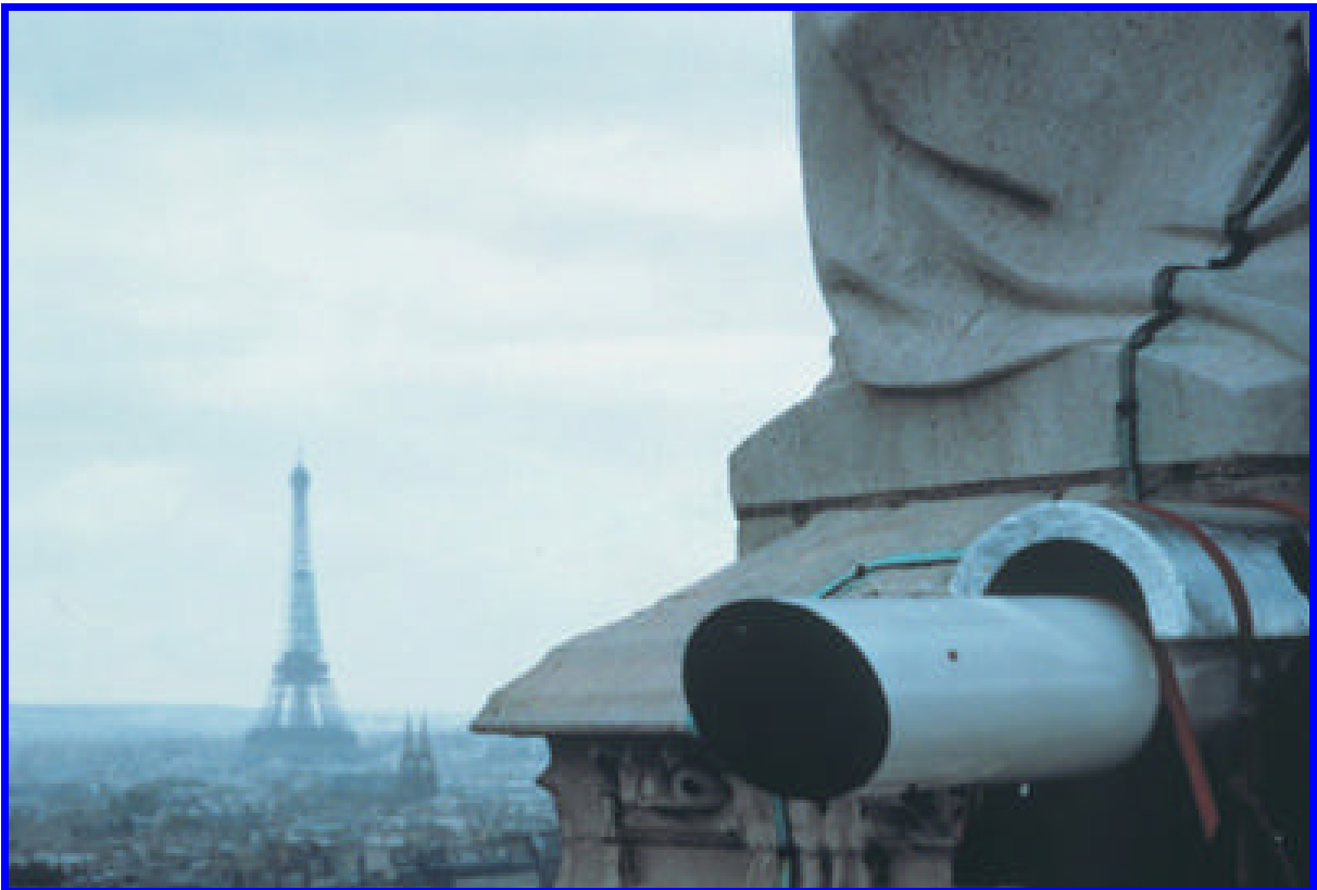
CNRS Photothèque - GOUTAIL Florence - Projecteur du SANOVA, appareil de mesures de pollution à Paris.
