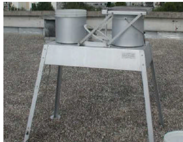
Figure 13. Collecteur de retombées atmosphériques sèches et humides (MTX ARS 1000, Modane, Italie) à Créteil.
