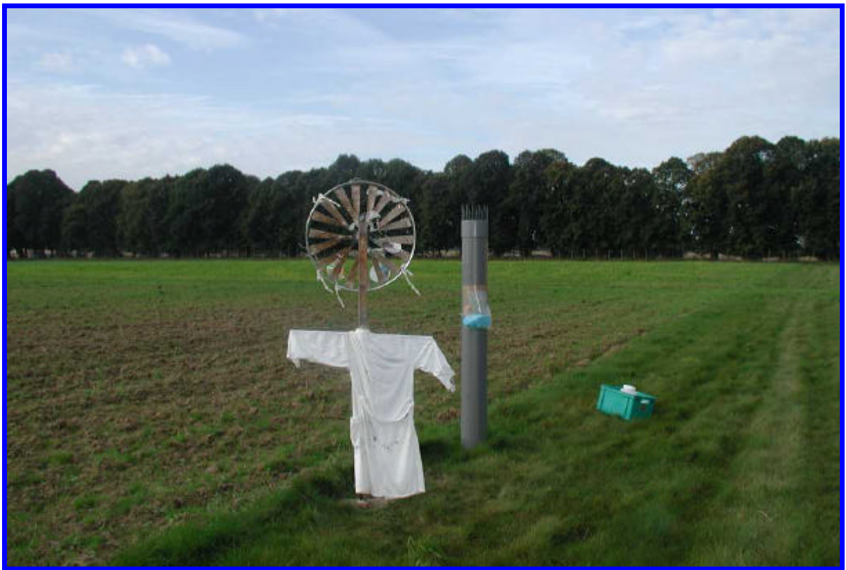
CEREVE - AZIMI Sam - Collecteur de retombées atmosphériques métalliques.
