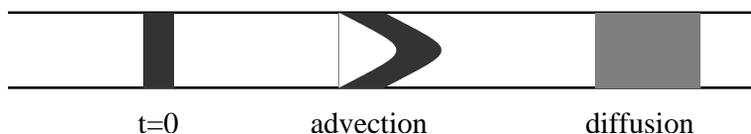
FIG. 3.1 – Principe de la dispersion de Taylor.
