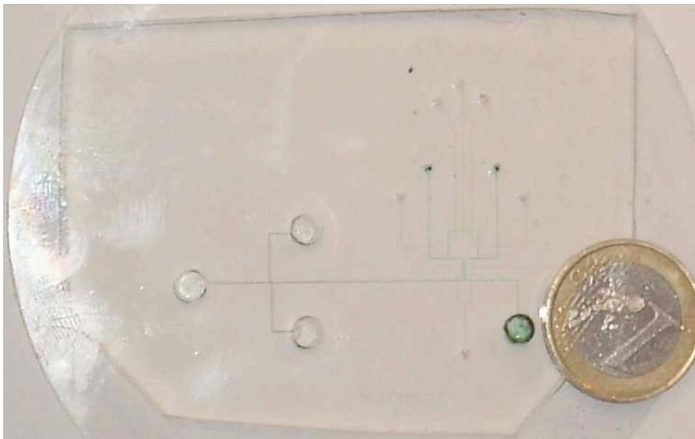
FIG. 2.2 – Photographie du microsysteme. Les canaux fluidiques sont remplis d'un colorant vert. L'épaisseur typique des canaux est de 20 microns pour une largeur de 100 microns.
