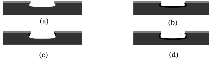
FIG. 2.5 – Principe de la DRIE. La première étape de gravure (a) est suivie du dépôt d’une couche protectrice (b) qui résiste à l’attaque indirecte durant la deuxième étape de gravure (c). Le cycle de protection-gravure se poursuit ensuite (d).
