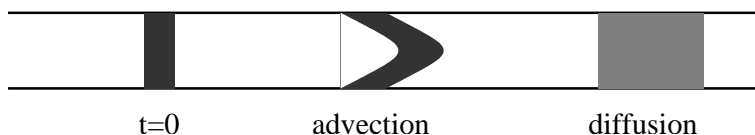
FIG. 3.1 – Principe de la dispersion de Taylor.
