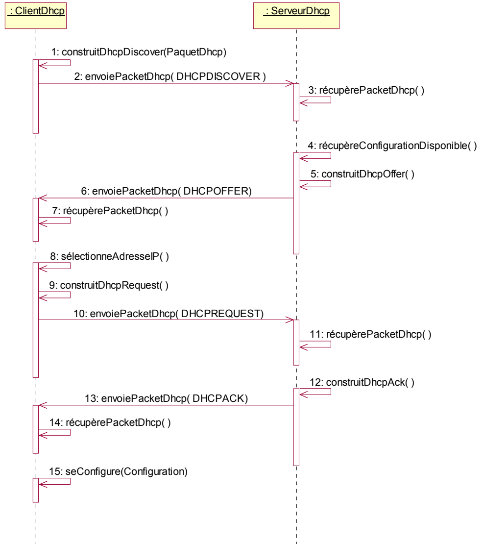
Figure 7-6 Diagramme de séquence – configuration DHCP
