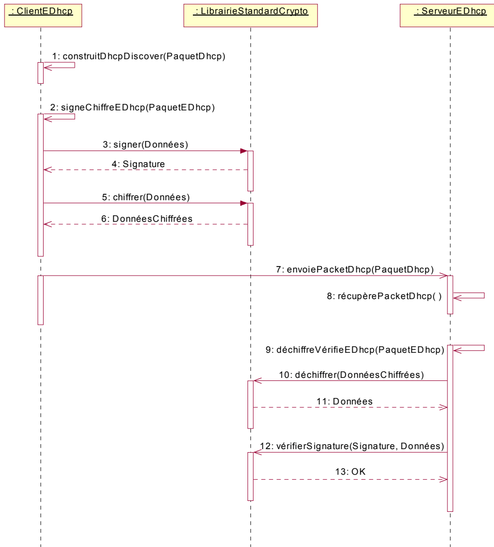
Figure 7-12 Diagramme de séquence – signature et chiffrement d’un paquet E-DHCP
