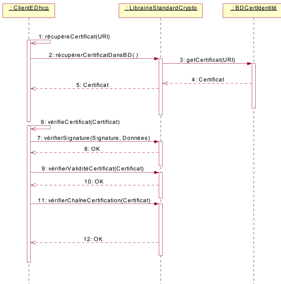
Figure 7-11 Diagramme de séquence – récupération et vérification d'un certificat
