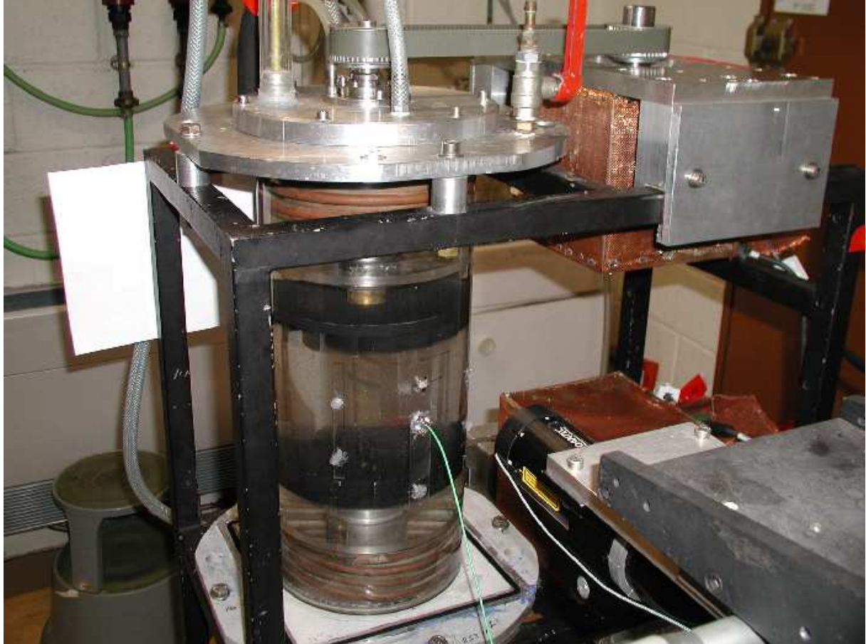
FIG. 1.3: Photographie du dispositif expérimental : les turbines sont peintes en noir. On distingue également les plaques de plexiglas de part et d'autre des turbines, ainsi que les serpentins de cuivre permettant la régulation thermique. En haut, sur la platine en aluminium, un tuyau est relié à un vase d'expansion suspendu au plafond. La courroie relie la poulie de la cage à roulements au moteur, enchâssé dans la cage en tissu de cuivre visible en haut à droite. Le fil vert relie un capteur de pression piézoélectrique monté en paroi à un amplificateur de charges. Le passage de capteur sert également aux mesures de températures par thermorésistance de platine (Pt100). Un thermomètre à alcool monté dans un doigt de gant et situé sur la platine supérieure permet un contrôle de la température.
