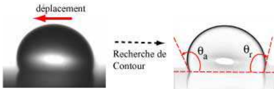
FIG. 4.1: Mesure des angles de contact d'avancée et de reculée. Le substrat est ici un wafer de silicium silanisé, d'où la présence de l'image réfléchie.
