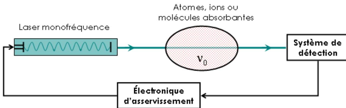
Figure A-4 : Schéma de principe d'un étalon de fréquences optiques. La fréquence du laser asservi correspond à la fréquence  $\nu_0$  de la transition des molécules absorbantes utilisées comme référence.
