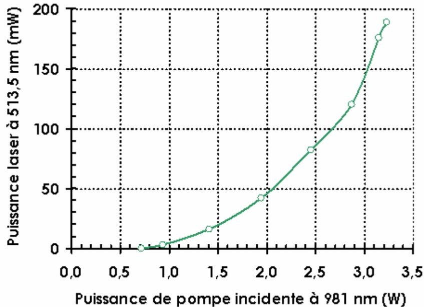
Figure B-30 : Puissances laser obtenus à 513,5 nm avec Yb:KYW et KNbO<sub>3</sub> dans une cavité hautement réfléchissante.
