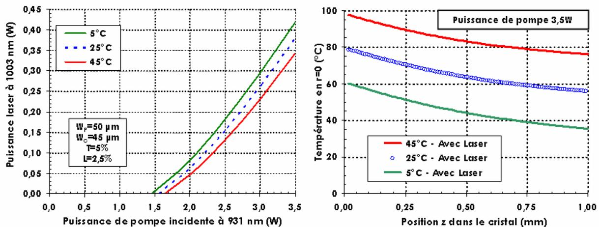
*A gauche* : Influence de la température de la monture sur les performances laser du cristal de Yb:KYW pompé à 930 nm par la diode fibrée et émettant à 1003 nm. *A droite* : Evolution de la température en °C suivant la position  $z$  dans le cristal au centre de la zone pompée ( $r=0$ ) avec effet laser et pour 3,5W de puissance de pompe.
