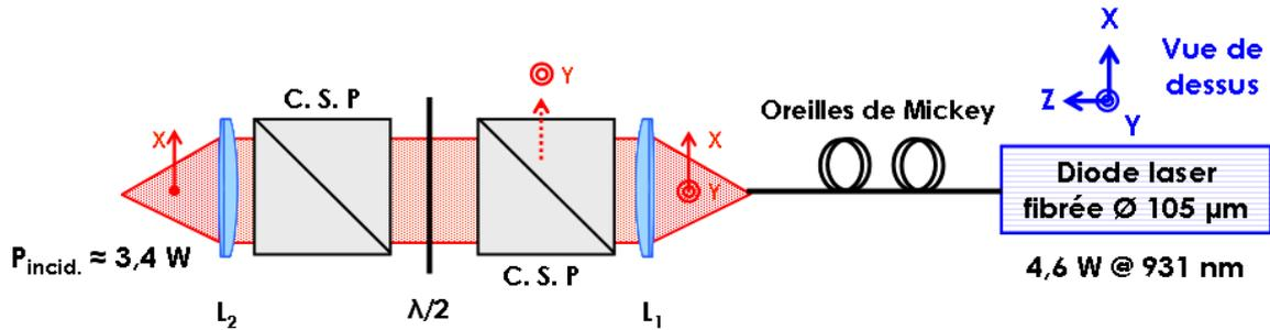
Figure B-31 : Banc de pompe fibré polarisé avec variateur de puissance. C.S.P. sont des cubes séparateurs de polarisation,  $L_1$  et  $L_2$  sont deux doublets de longueurs focales respectives 80 et 60 mm.
