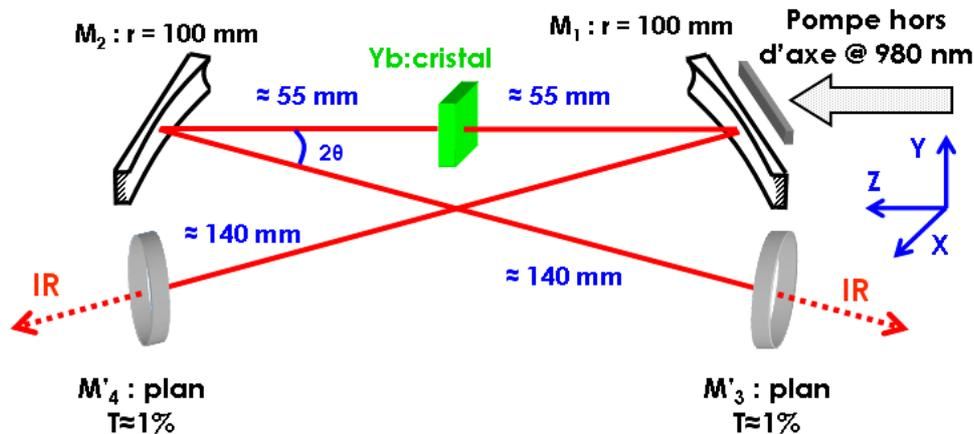
Les miroirs plans  $M'_3$  et  $M'_4$  doivent être amovibles pour pouvoir facilement passer de cette sous-cavité linéaire de réglage à la cavité en anneau finale. Pour cela, nous avons utilisé des supports de monture en laiton amovibles à trois points (billes en acier) plans. Ces montures encombrantes peuvent avantageusement être remplacées par des montures amovibles, par exemple de type NewFocus (Flipper™ Mount 9891).
