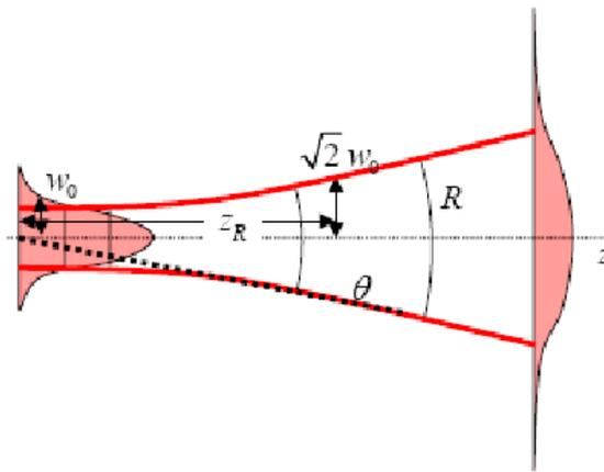
Figure B-11 : Illustration de la divergence d'un faisceau laser gaussien  $TEM_{00}$  et de la longueur de Rayleigh  $Z_R$ .  $R$  est le rayon de courbure de l'onde et  $\theta$  son demi angle de divergence.
