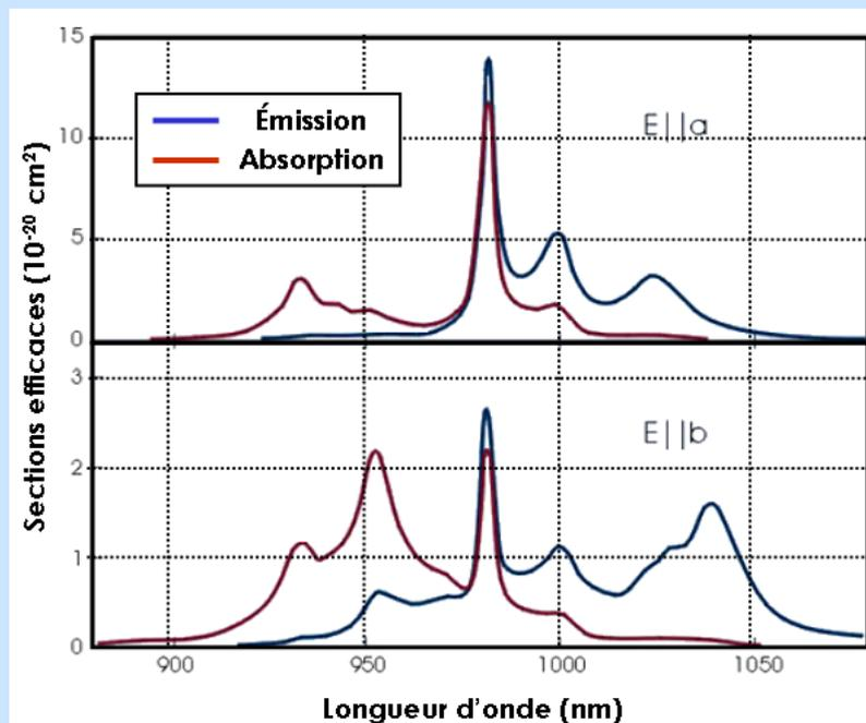
Spectres d'absorption (en rouge) et d'émission (en bleu) selon les deux polarisations accessibles (**a** et **b**) de  $\text{Yb:KYW}$ .
