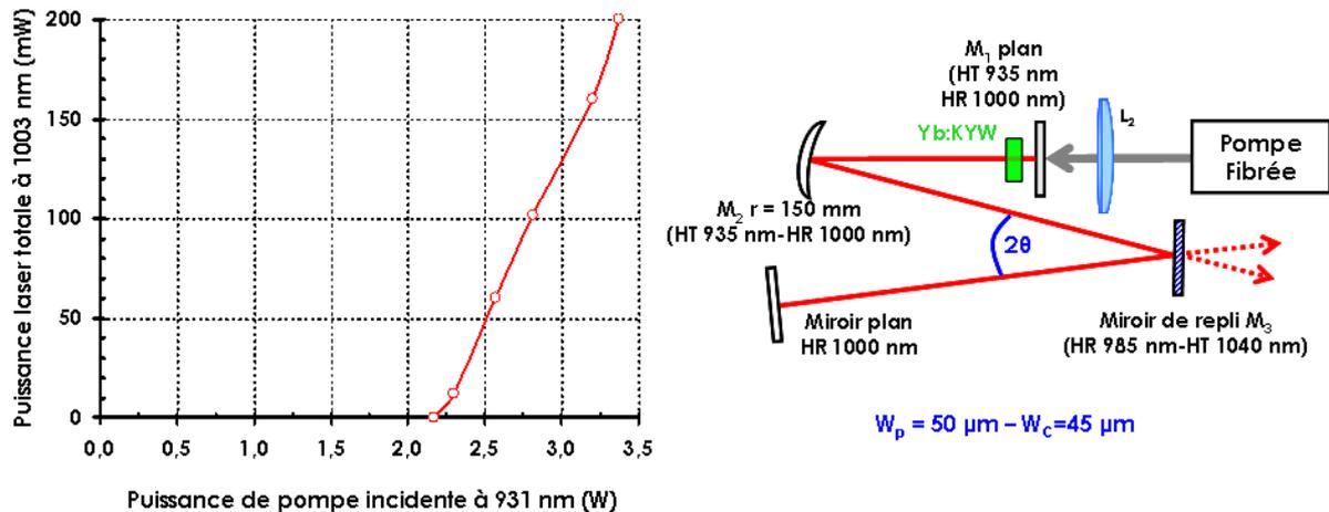
Figure B-32 : A gauche : Schéma de la cavité utilisée. A droite : Puissance laser totale à 1003 nm en fonction de la puissance de pompe incidente polarisée suivant l'axe  $a$  du Yb:KYW. La longueur d'onde de pompe est fixe à 931 nm.
