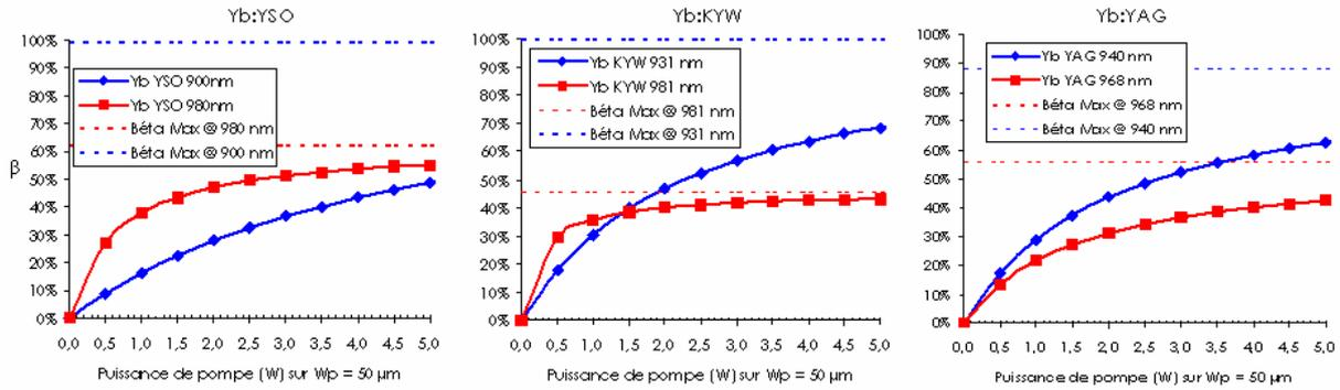
Figure B-7 : Comparaison de l'évolution du taux d'inversion de population  $\beta$  à deux longueurs d'ondes de pompe pour les cristaux de Yb:YSO, Yb:KYW et Yb:YAG. Les limites en pointillés correspondent aux valeurs maximales de  $\beta$  pour les différentes longueurs d'ondes de pompe, lorsque la puissance de pompe tend vers l'infini.
