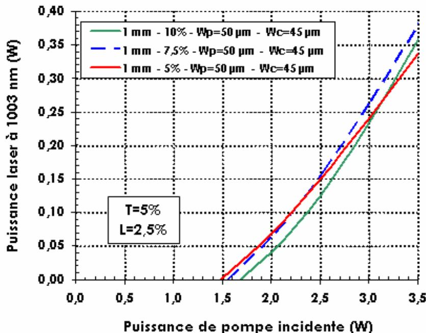
Figure B-43 : Puissance laser en fonction de la puissance de pompe à 931 nm pour des cristaux de 1 mm de long et de dopages différents. Le waist laser est fixé à 45  $\mu\text{m}$  et le rayon de pompe à 50  $\mu\text{m}$ .
