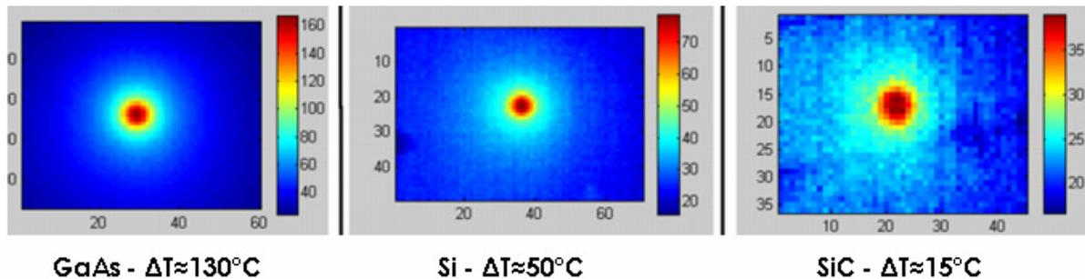
Figure C-12 : Cartographies de températures pour des structures identiques mais des substrats différents sous l'influence d'un pompage optique (4W) sur un diamètre de 500  $\mu\text{m}$ . Les échelles de température de chaque image sont différentes, mais sont représentées sur la droite de chacune.  $\Delta T$  est la différence de température entre le centre de la zone pompée et le substrat éloigné de la zone de pompe.
