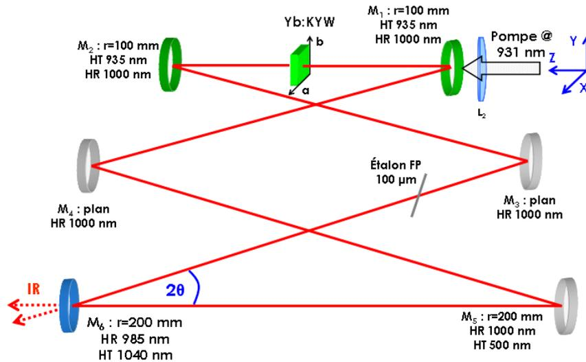
Figure B-33 : Cavit  en anneau utilis e avec le cristal de Yb:KYW pomp    931 nm pour l'oscillation laser   1020 nm.
