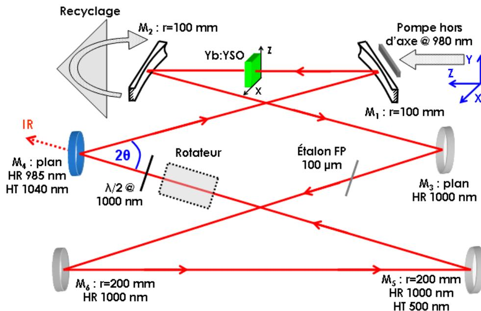
Figure B-22 : Schéma de la cavité à 6 miroirs en anneau utilisée à 1003,4 nm.  $\theta$  vaut ici environ  $15^\circ$ .  $M_1$ - $M_2 \approx 110$  mm,  $M_2$ - $M_3 \approx 230$  mm,  $M_3$ - $M_6 \approx 310$  mm,  $M_6$ - $M_5 \approx 245$  mm,  $M_5$ - $M_4 \approx 290$  mm,  $M_4$ - $M_1 \approx 240$  mm.
