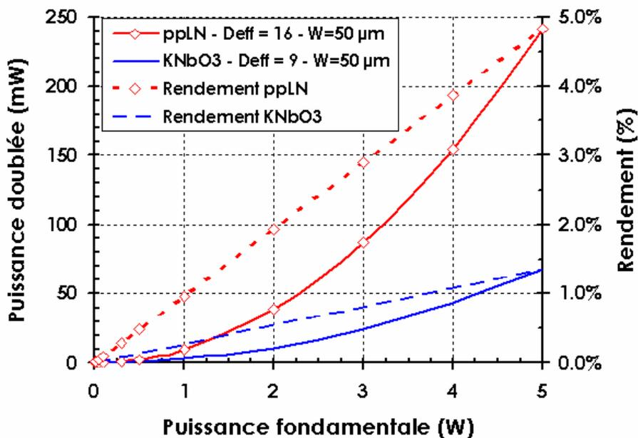
Figure A-18 : Puissances converties à 500 nm et rendements associés en fonction de la puissance infrarouge incidente pour des cristaux de ppLN (rouge) et de  $\text{KNbO}_3$  (bleu) de 10 mm de long et un rayon au waist de  $50 \mu\text{m}$ .
