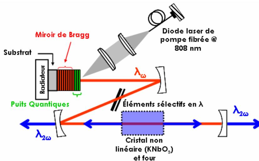
Figure C-1 : Schéma de principe du laser à base de semiconducteurs pompés optiquement dont le rayonnement infrarouge est doublé en fréquence intracavité.
