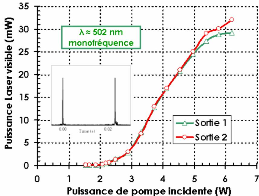
Figure C-20 : Puissances laser visibles (502 nm) en fonction de la puissance de pompe incidente à 808 nm par doublement de fréquence de l'émission infrarouge de la  $\frac{1}{2}$  structure VCSEL dans un cristal de  $\text{KNbO}_3$ . L'encadré représente le signal transmis par l'interféromètre Fabry-Perot d'analyse montrant que l'émission est monomode longitudinale à 1004 nm.
