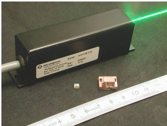
Figure A-9 : Laser MicroCOB utilisant un cristal autodoubleur de fréquence (Nd:GdCOB).
