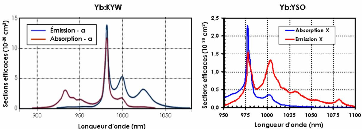
Figure B-27 : Spectres d'absorption et d'émission des cristaux de Yb:KYW (polarisation  $\alpha$ ) et de Yb:YSO (polarisation X).
