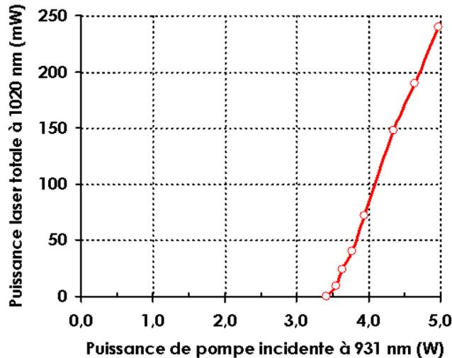
Figure B-34 : Efficacité laser à 1020 nm pour le cristal de Yb:KYW pompé à 931 nm par diode fibrée dans une cavité en anneau bidirectionnelle.
