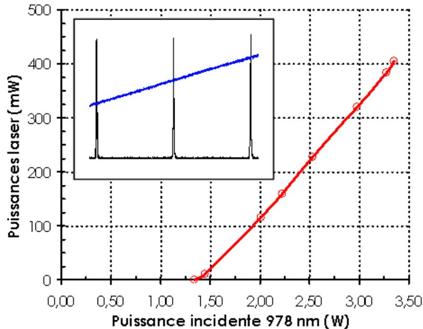
Figure B-23 : Puissances laser à 1003,4 nm mesurées derrière  $M_4$  ( $T=5\%$ ) en fonction de la puissance de pompe en régime monomode longitudinal. Le cadre inséré est le signal transmis par l'interféromètre Fabry-Perot d'analyse à balayage.
