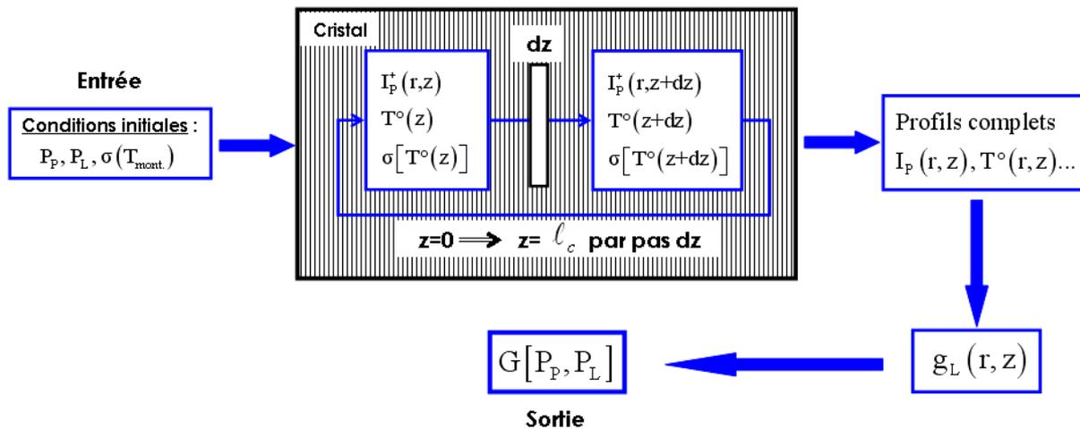
Figure B-36 : Schéma représentant le principe de fonctionnement du module permettant de calculer le gain net laser  $G$  correspondant à une valeur de la puissance de pompe incidente  $P_p$  et de la puissance laser de sortie  $P_L$ . La lettre  $\sigma$  représente l'ensemble des sections efficaces d'absorption et d'émission aux longueurs d'ondes pompe et laser.
