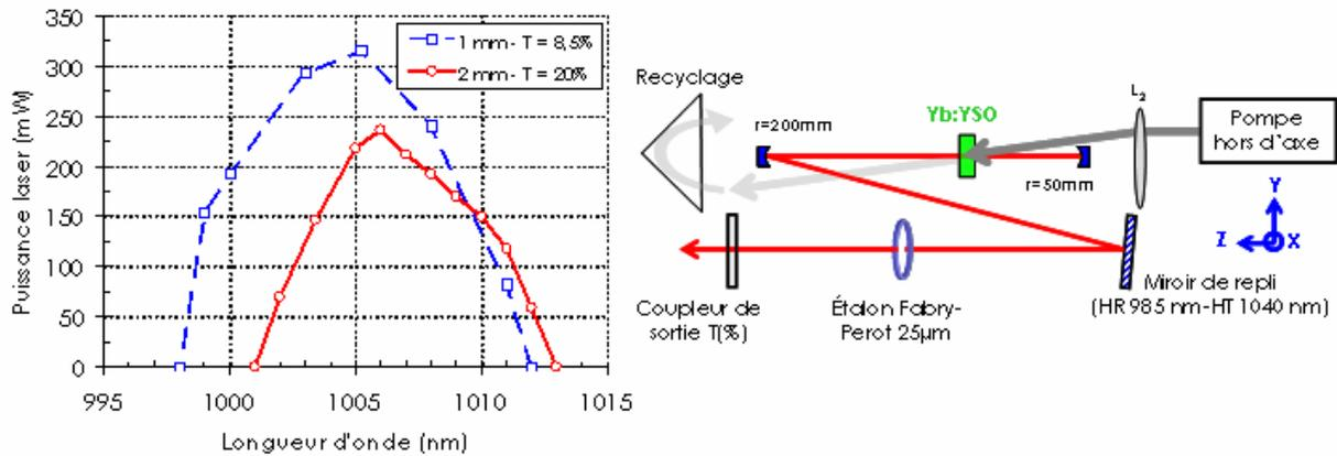
Figure B-21 : A gauche : Puissances laser extraites en fonction de la longueur d'onde pour les cristaux de Yb:YSO de 1 mm (en bleu) et de 2 mm (en rouge). La puissance de pompe incidente est de 3W. A droite : Schéma expérimental de la cavité en Z utilisée.
