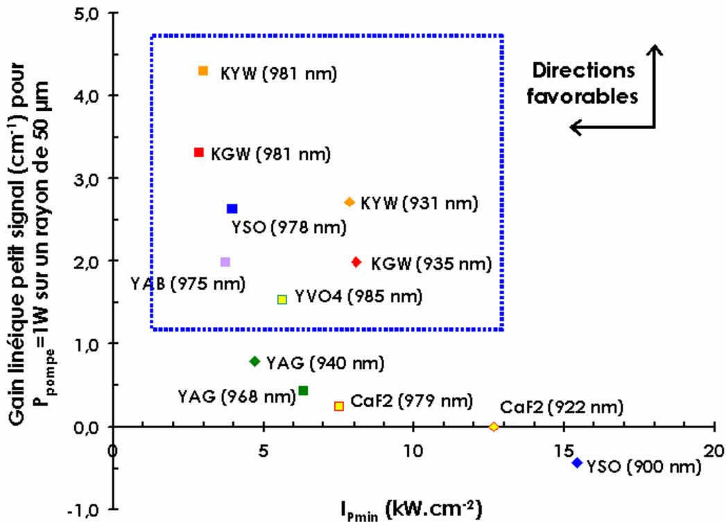
Figure B-10 : Comparaison des intensités de pompe pour atteindre la transparence à la longueur d'onde laser  $I_{pmin}$  et du gain linéique petit signal à 1003 nm pour une puissance de pompe de 1W focalisée sur un rayon de 50  $\mu\text{m}$ , pour différents cristaux dopés ytterbium. La longueur d'onde de pompe et le nom de la matrice hôte sont notés à côté de chaque point calculé.
