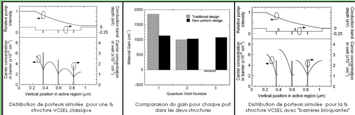
Distribution des porteurs de charges dans les puits quantiques pour une 1/2 structure VCSEL conventionnelle et pour une 1/2 structure VCSEL avec "barrières bloquantes" de porteurs pour homogénéiser la densité de porteurs dans chaque puits quantique. Tiré de [Geske, 04].
