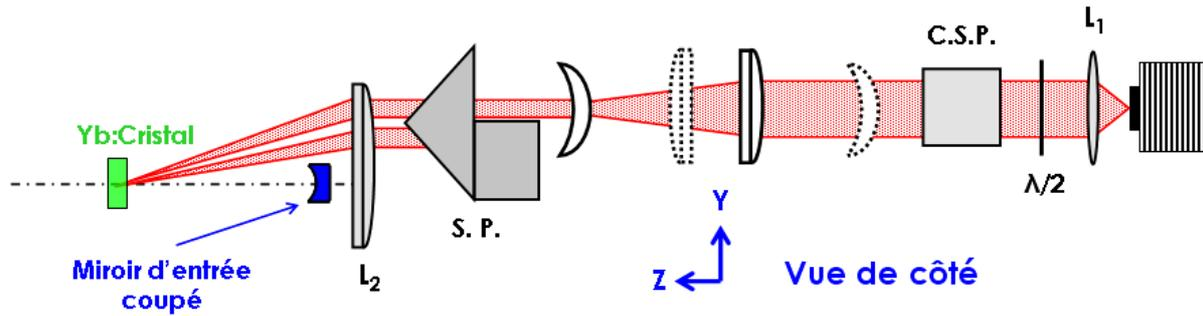
Le faisceau de pompe doit finalement être focalisé dans le cristal par-dessus le miroir coupé d'entrée (préalablement réglé en autocollimation à une hauteur de 12 cm). On veillera à ne pas occulter le faisceau par ce miroir, ni par le doublet  $L_2$ . La focalisation est très proche de l'optimum quand la fluorescence visible du cristal est intense et que la puissance de pompe transmise est maximale (absorption saturée).
