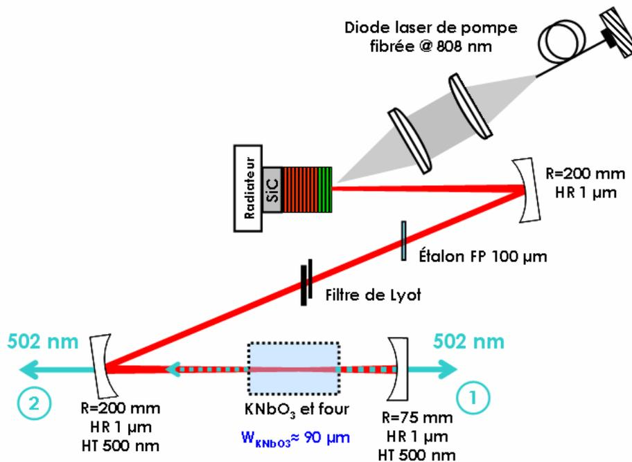
Figure C-19 : Cavité à 4 miroirs utilisée pour le doublement de fréquence de l'infrarouge vers le visible. Le mode de cavité au niveau de la  $\frac{1}{2}$  structure VCSEL est d'environ  $100 \mu\text{m}$  et d'environ  $90 \mu\text{m}$  au niveau du cristal non linéaire.
