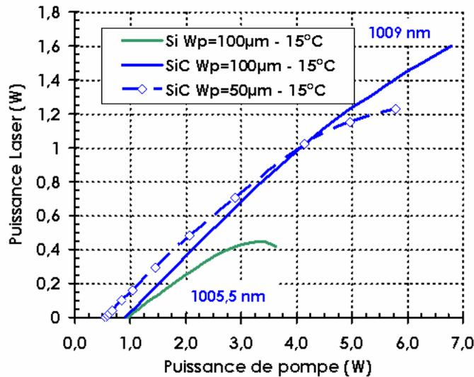
Figure C-15 : Puissance laser en fonction de la puissance de pompe pour les structures reportées sur Si et SiC pour un rayon de pompe de 100  $\mu\text{m}$  (traits pleins) et sur SiC pour un rayon de pompe de 50  $\mu\text{m}$  (en pointillés). Le miroir de sortie a une transmission d'environ 1% autour de 1000 nm. Les longueurs d'ondes correspondent au seuil et au maximum de l'émission laser de la structure sur SiC pompée sur un rayon de 100  $\mu\text{m}$ .
