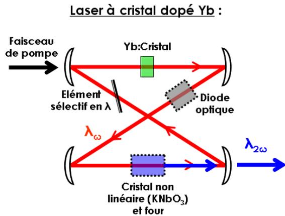
Figure A-22 : Schéma de principe de la solution à base de cristaux dopés ytterbium, émettant dans l'infrarouge, pompés par diode et doublé intracavité.
