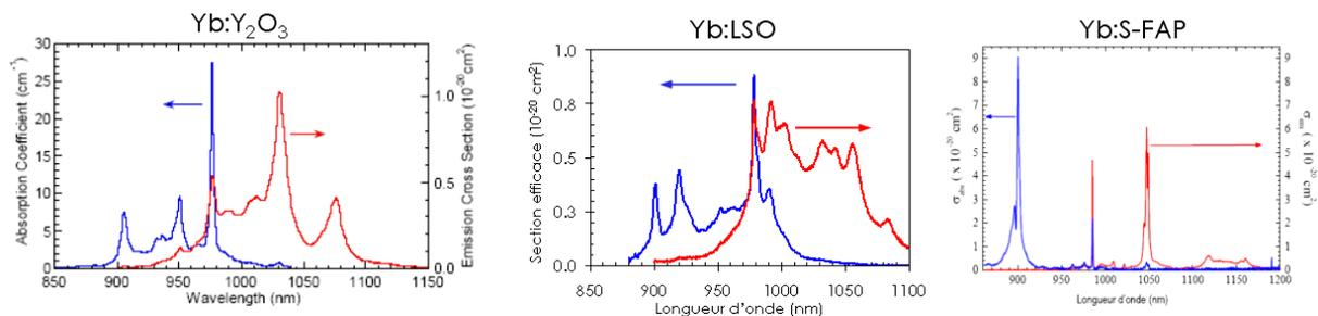
Figure B-3 : Spectres d'absorption et d'émission des Yb:Y<sub>2</sub>O<sub>3</sub>, Yb:LSO et Yb:S-FAP.
