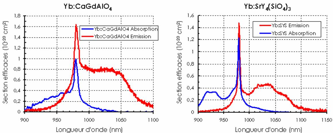
Figure B-2 : Spectres d'émission et absorption des cristaux de Yb:CaGdAlO<sub>4</sub> (gauche) et Yb:SYS ( $\text{Yb}^{3+}:\text{SrY}_4(\text{SiO}_4)_3\text{O}$ ) (droite). Une seule des deux polarisations du Yb:CaGdAlO<sub>4</sub> (cristal uniaxe) est représentée.
