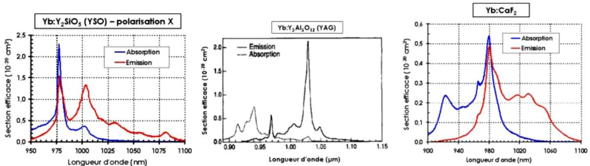
Figure A-12 : Spectres d'émission et d'absorption du Yb:YSO, du Yb:YAG et du Yb:CaF<sub>2</sub>.
