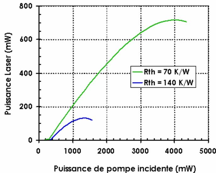
Figure C-7 : Puissance laser en fonction de la puissance de pompe incidente pour des substrats de conductivités thermiques différentes ( $45 \text{ W.m}^{-1}\text{.K}^{-1}$  et  $90 \text{ W.m}^{-1}\text{.K}^{-1}$ ), correspondant à des résistances thermiques de  $140$  et  $70 \text{ K.W}^{-1}$  pour un rayon de pompe de  $50 \text{ }\mu\text{m}$ .
