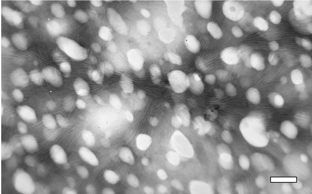
Figure 80: Observations MET d'une ébauche de sphérolite au cœur d'un barreau injecté de polyamide-12 renforcé par 20% EPRm. (barre d'échelle = 200 nm)
