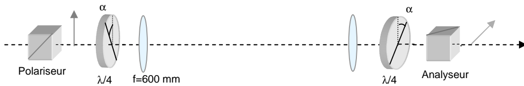
Figure 3.3 : Dispositif expérimental du filtre non linéaire.
