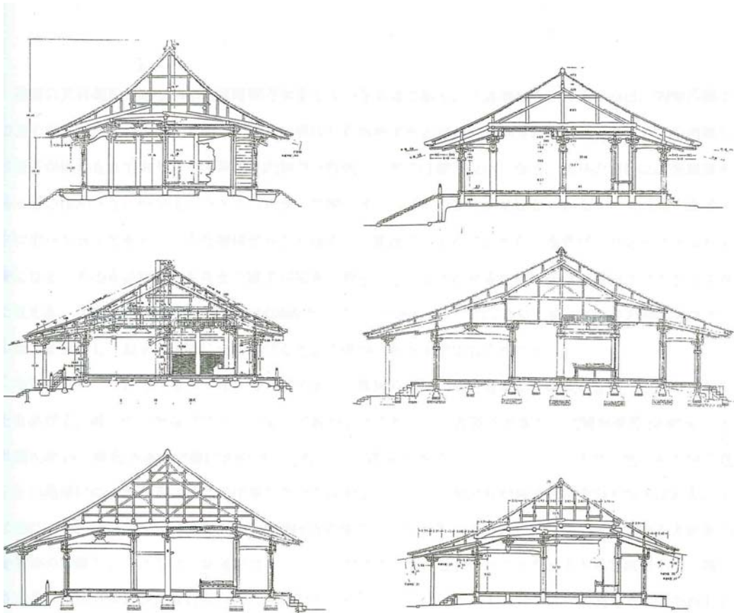
Figure 835 Coupes des temples avec le « Kondô » et le « Raidô » dont la hauteur des deux plafonds décalés, Temples de Kakurinji, de Taisanji, de Chôkyûji, de Daihônji, de Rokuharamitsuji, de Motoyamadera, 1/400
