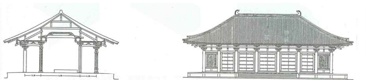
图 3-4 唐招提寺金堂复原侧面、正面断面图
