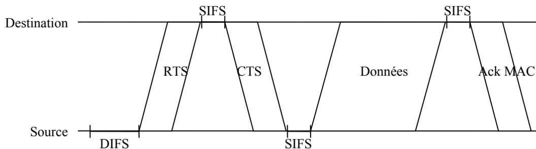
Figure 22: Communication entre la source et la destination en 802.11.
