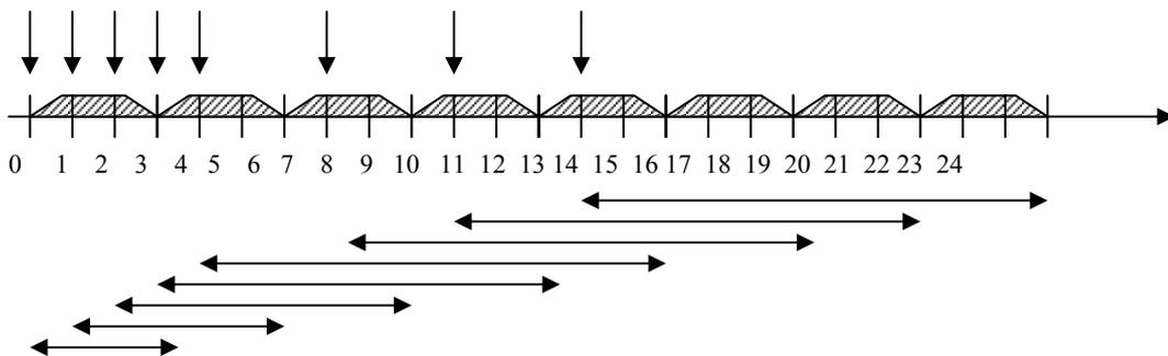
Figure 13: Scénario de transmission des paquets sous EDF.
