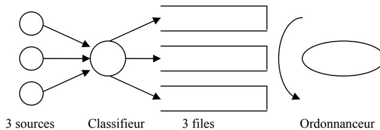
Figure 25: Schéma d'un ordonnanceur de 3 classes
