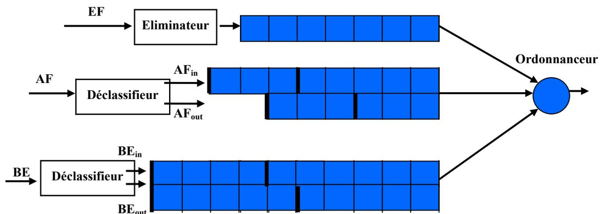
Figure 27: La différenciation de service dans les nœuds du réseau
