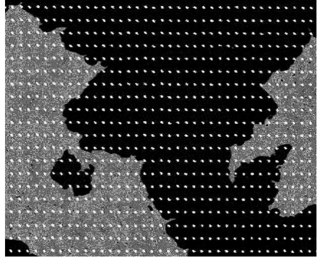
Figure 2.10 : Image numérique d'un biphase fer/cuivre
