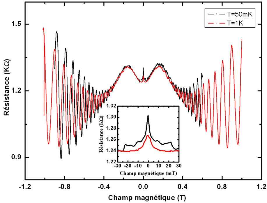
FIG. VI.8: La magnétorésistance des fils GaAs/Al<sub>0.3</sub>Ga<sub>0.7</sub>As de l'échantillon TC04 à  $V_g=0$  V ( $W_{nominal}=620$  nm) mesurée à  $T=50$  mK (courbe noire) et à  $T=1$  K (courbe rouge), l'encadré est un zoom du pic de la localisation faible.
