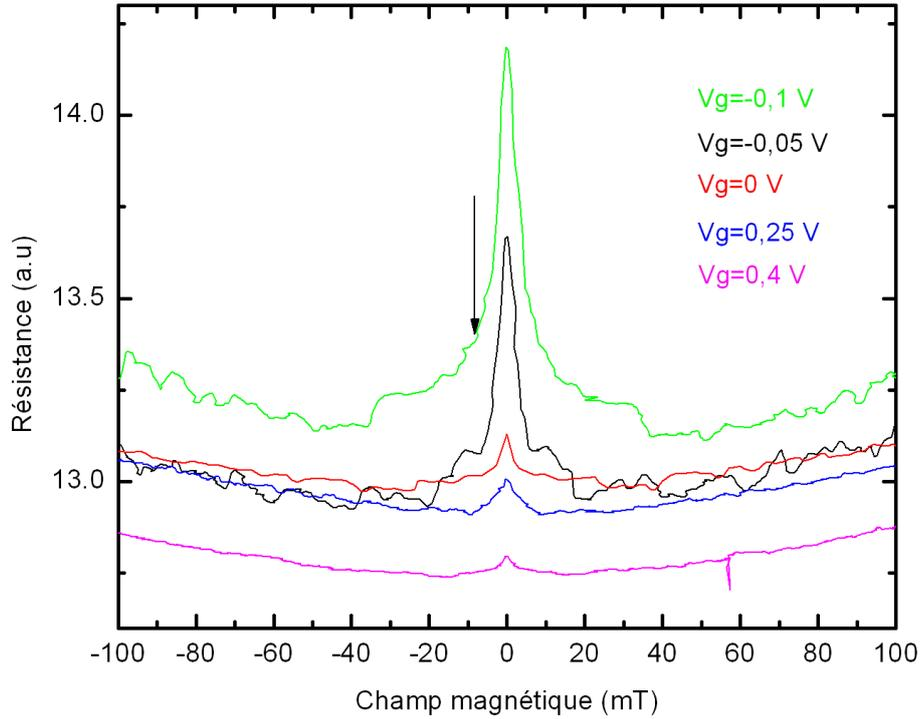
FIG. VI.10: La résistance des fils de largeur nominale  $W=620$  nm mesurée à 50 mK pour différentes valeurs de la tension de grille. La flèche indique le champ "crossover" entre deux régimes faible champ magnétique et fort champ magnétique.
