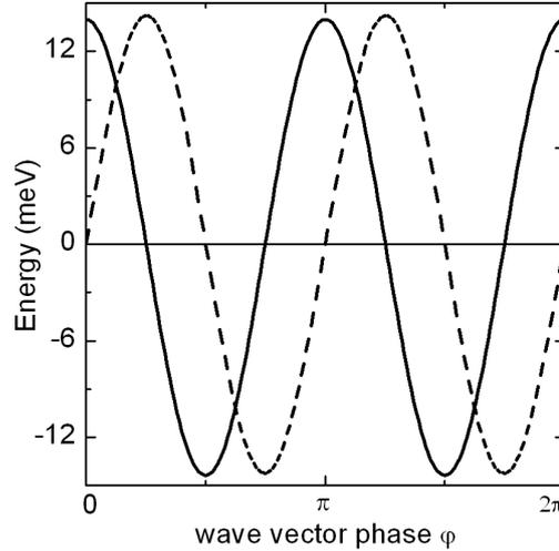
FIG. II.2: La partie imaginaire (trait pointillé) et la partie réelle (trait continu) de l'énergie propre de la bande de conduction  $\Gamma_{6c}$  en fonction de la phase  $\varphi$  du vecteur d'onde pour  $|k| = 0.01 (2\pi/a)$ . L'origine de l'énergie est prise en bas de la bande de conduction  $\Gamma_{6c}$ .
