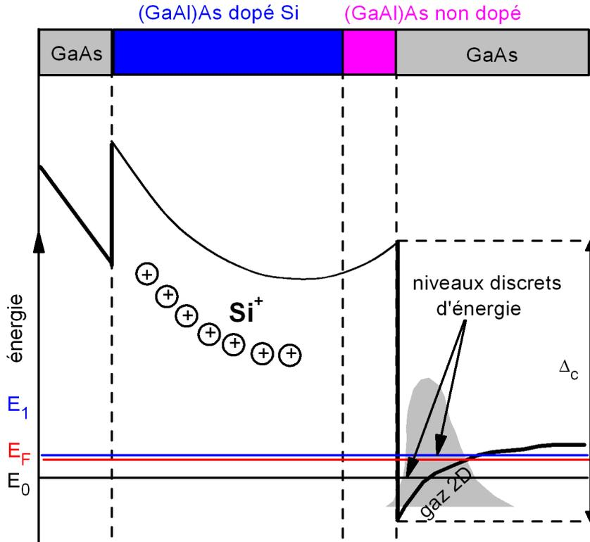
FIG. I.2: Alternance des couches déposées et profil des bandes d'une hétéro-jonction GaAs/Al<sub>x</sub>Ga<sub>1-x</sub>As et formation du gaz bidimensionnel d'électron (ou de trou) à l'interface entre GaAs et Al<sub>x</sub>Ga<sub>1-x</sub>As. Les électrons (ou trous) sont maintenus contre Al<sub>x</sub>Ga<sub>1-x</sub>As par le champ électrique venant du dopants chargés (+) de silicium dans Al<sub>x</sub>Ga<sub>1-x</sub>As.
