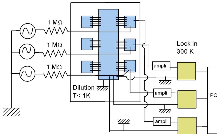
FIG. VI.5: Le schéma du dispositif de l'expérience. Trois lock-in en parallèle permettent de mesurer en même temps les tensions aux bornes de trois ensembles de fils quantiques de tailles différentes. Le courant injecté aux échantillons est fourni par la source. Une résistance de  $1\text{M}\Omega$  en série permet de contrôler le courant injecté.
