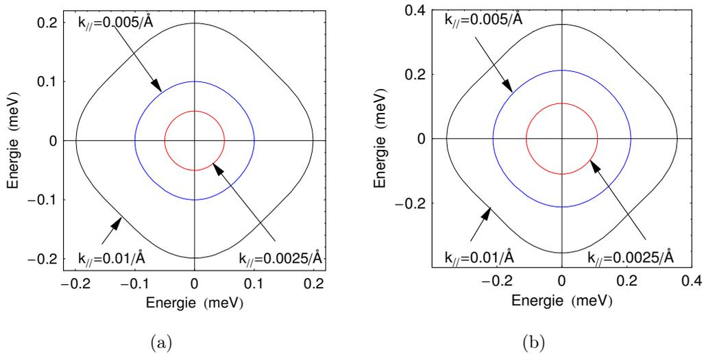
FIG. III.4: La variation angulaire du splitting de spin dans la bande de conduction (a) et dans la bande de valence (b) du puits quantique Al<sub>0.3</sub>Ga<sub>0.7</sub>As/GaAs 100 Å de large, calculés en tenant compte du terme d'interface.
