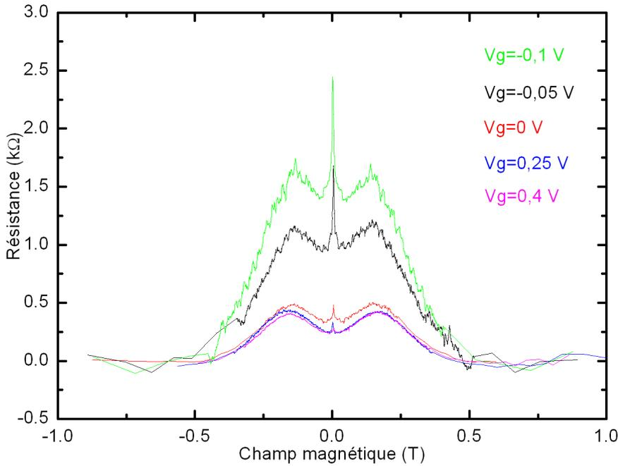
FIG. VI.9: La magnétorésistance des fils quantiques de l'échantillon TC04 ( $W_{nominal}=620$  nm) mesurée à  $T=50$  mK en fonction du champ magnétique avec plusieurs tension de grille variant de  $-50$  meV à  $400$  meV.
