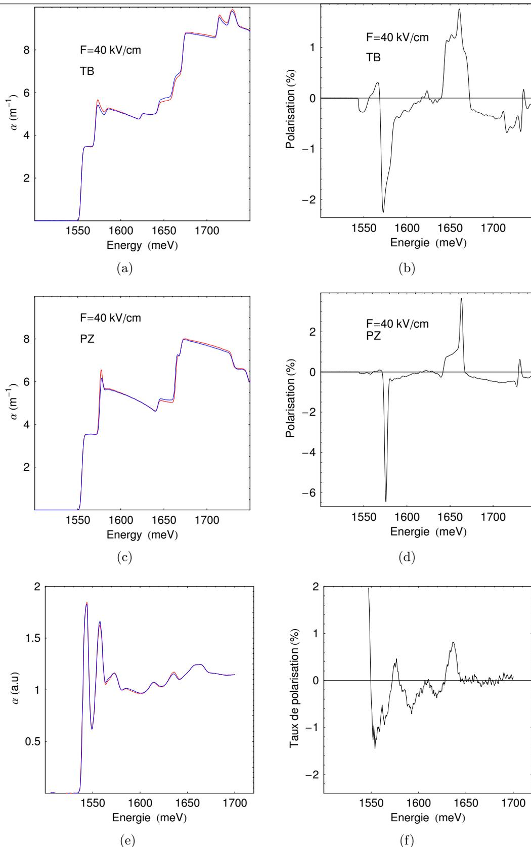
FIG. III.6: Absorption et taux de polarisation d'un puits quantique GaAs/Al<sub>0.3</sub>Ga<sub>0.7</sub>As 100 Å de large sous 40 kV/cm, calculées en utilisant l'ensemble des paramètres TB (figures a et b), l'ensemble des paramètres PZ (figures c et d) et les mesures en photocourant (figures e et f) (d'après la thèse de Sébastien Cortez [11]). Les courbes rouges et bleues correspondent respectivement aux directions [110] et [1-10].
