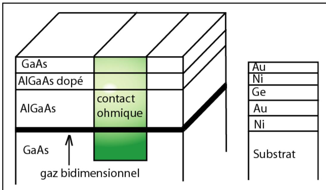
FIG. VI.4: Schéma de principe des contacts ohmiques.
