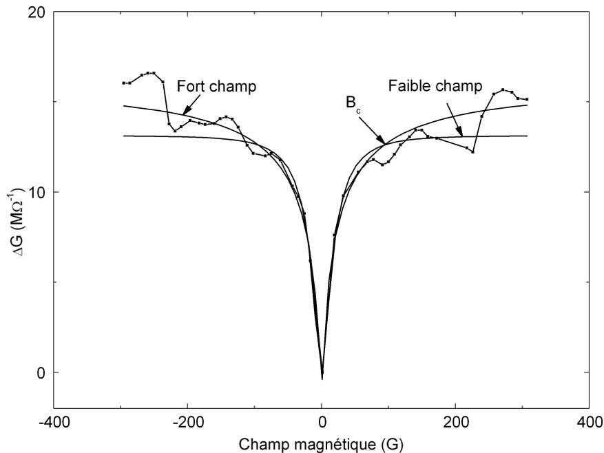
FIG. VI.11: La magnétoconductance des fils de largeur nominale  $L=620$  nm à la tension de la grille  $V_g=0$  V, à  $T=50$  mK et les deux courbes ajustées par l'équation V.42 pour deux cas : faible champ magnétique et fort champ magnétique. La flèche indique le champ magnétique de "cross-over".
