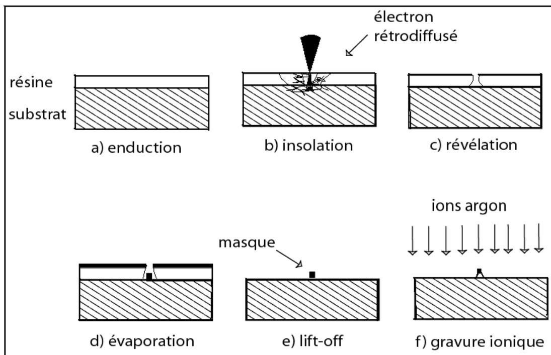
FIG. VI.3: Schéma des différentes étapes de la fabrication.
