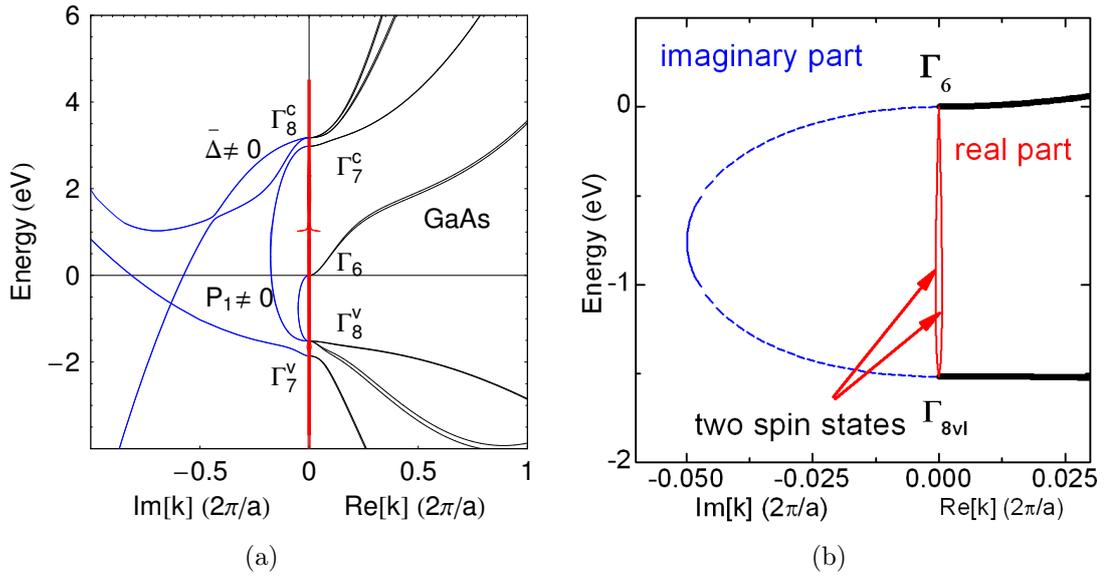
FIG. II.3: Structure de bande réelle et complexe du GaAs le long de la direction [110]. (a) vue globale de la structure de bande. (b) l'agrandissement de la boucle reliant la bande de conduction  $\Gamma_{6c}$  à la bande de trou léger  $\Gamma_{8v}^l$  : les bandes réelles (trait épais continu), la composante imaginaire (trait pointillé) et la composante réelle (trait mince continu) du vecteur d'onde évanescent.
