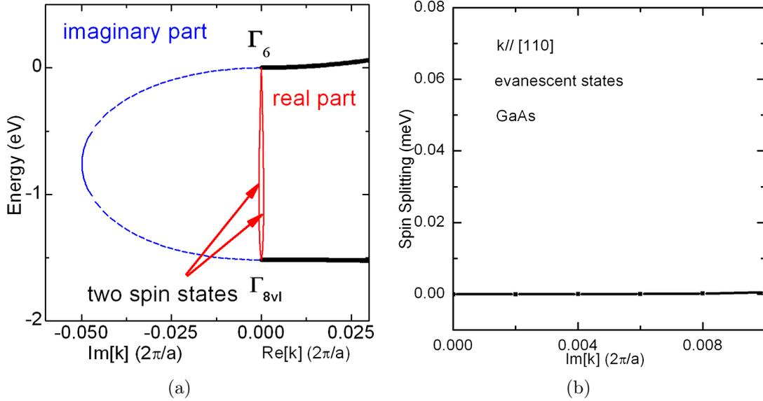
FIG. II.6: La boucle reliant de la bande de conduction  $\Gamma_{6c}$  à la bande de trou léger  $\Gamma_{8v}^l$  (a). Le splitting de spin des états évanescents en fonction de la partie imaginaire du vecteur d'onde suivant la direction  $[110]$  (b).
