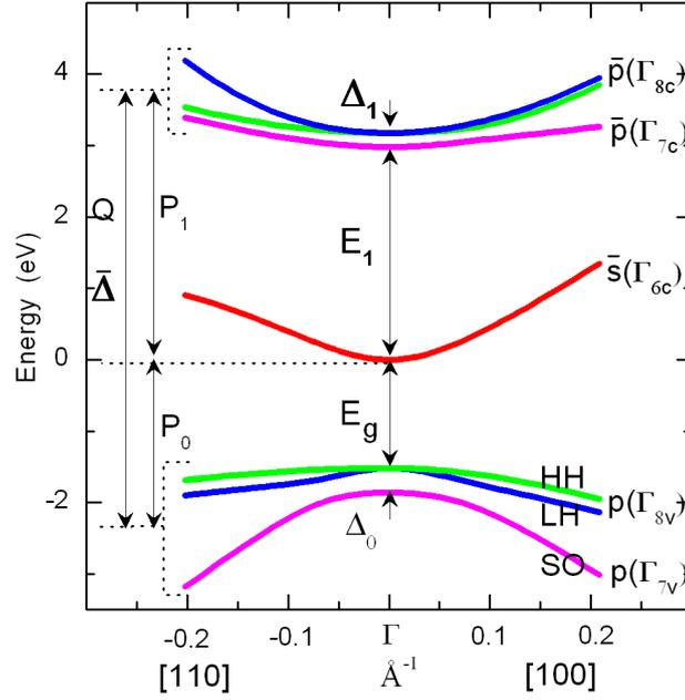
FIG. I.4: Diagramme de bande d'un semi-conducteur III-V proche du centre  $\Gamma$  de la zone de Brillouin. Les notations utilisées dans cette thèse sont précisées.
