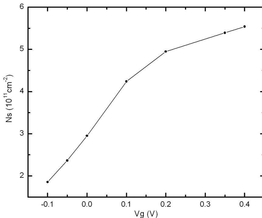
FIG. VI.7: La densité de porteurs mesurée à T=50 mK en fonction de la tension de grille de l'échantillon TC04 de largeur nominale W=620 nm. La densité de porteurs varie de  $1.8 \cdot 10^{11}\text{cm}^{-2}$  à  $6 \cdot 10^{11}\text{cm}^{-2}$  grâce à une variation de la tension de grille de -0.1 V à 0.4 V.
