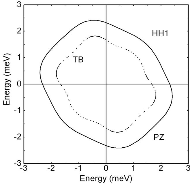
FIG. III.5: La variation angulaire du splitting de spin de la bande de valence de l'hétérojonction  $\text{Al}_{0.3}\text{Ga}_{0.7}\text{As}/\text{GaAs}$  dopé de  $p_s = 5 * 10^{11} \text{ cm}^{-2}$  dans la barrière, au niveau de Fermi  $k_F=0.0196 \text{ \AA}^{-1}$ . La courbe continue est obtenue en utilisant les paramètres PZ alors que celle pointillée est obtenue en utilisant les paramètres TB.
