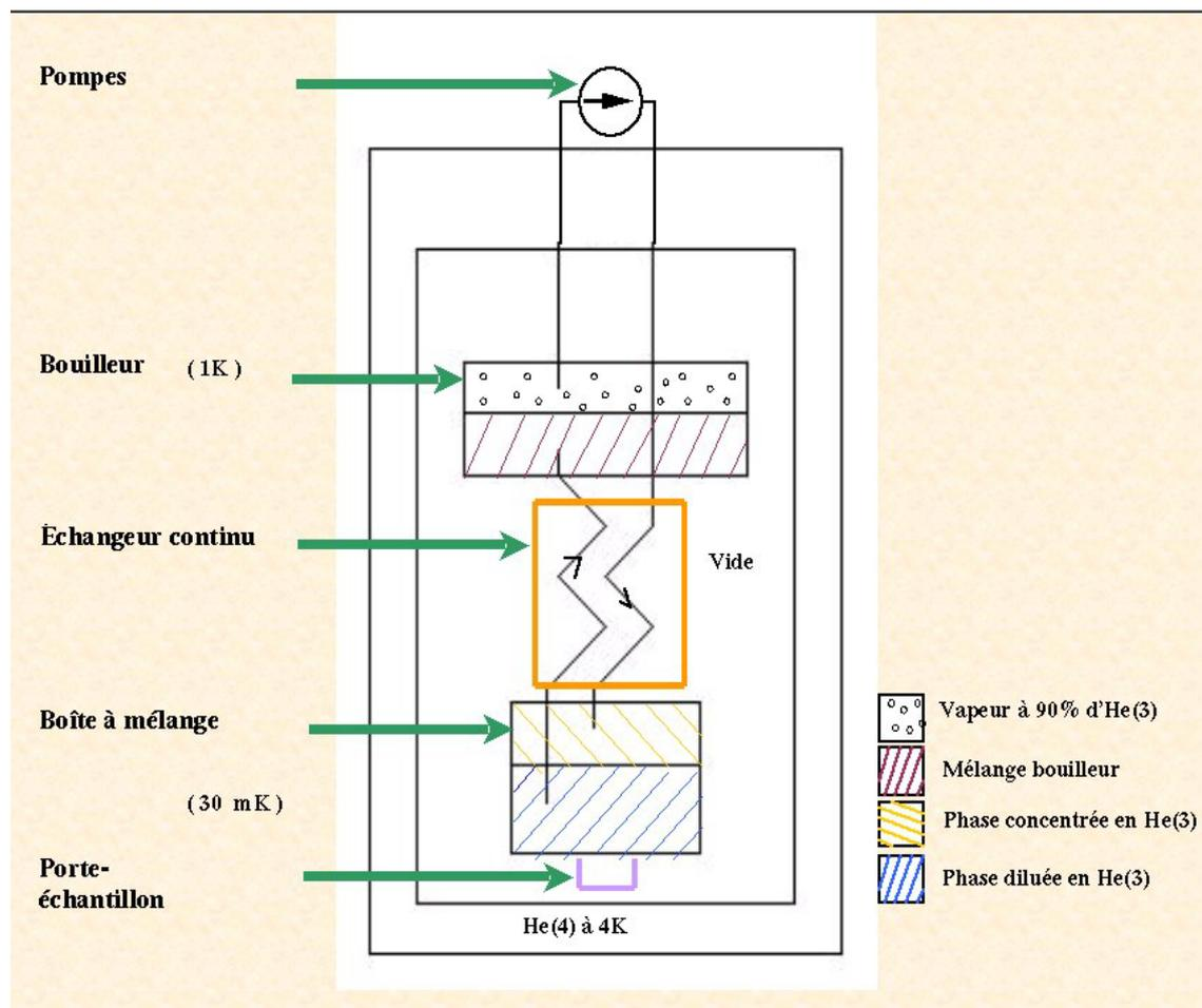
FIG. B-1: Le schéma principe de la diluette.
