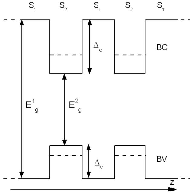
FIG. I.3: Profil de bande pour un multipuits quantique (ou super-réseau). Les niveaux d'énergies des états d'électron et de trous sont indiqués par les traits pointillés. Les notations  $\Delta_c$  et  $\Delta_v$  représentent l'offset de conduction et l'offset de valence.
