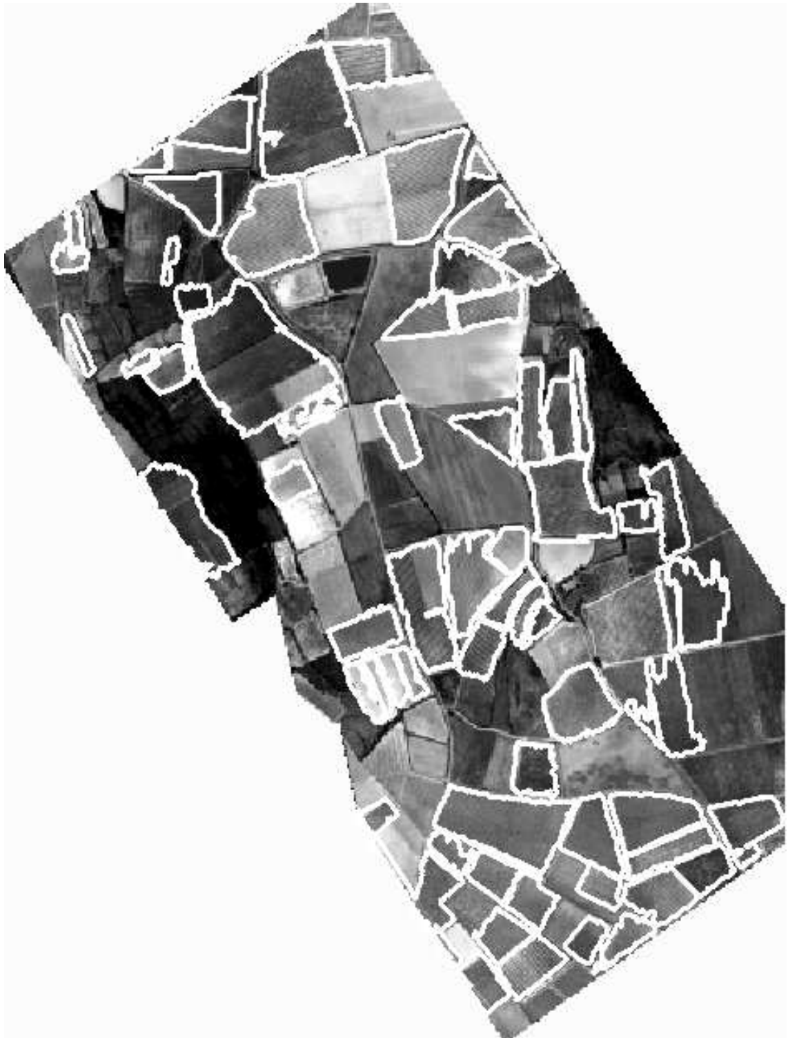
FIG. D.2: Résultats de segmentation par la méthode FGI. Image juin 2005 - canal rouge - résolution 0,5 m - taille fenêtre 30 m.
