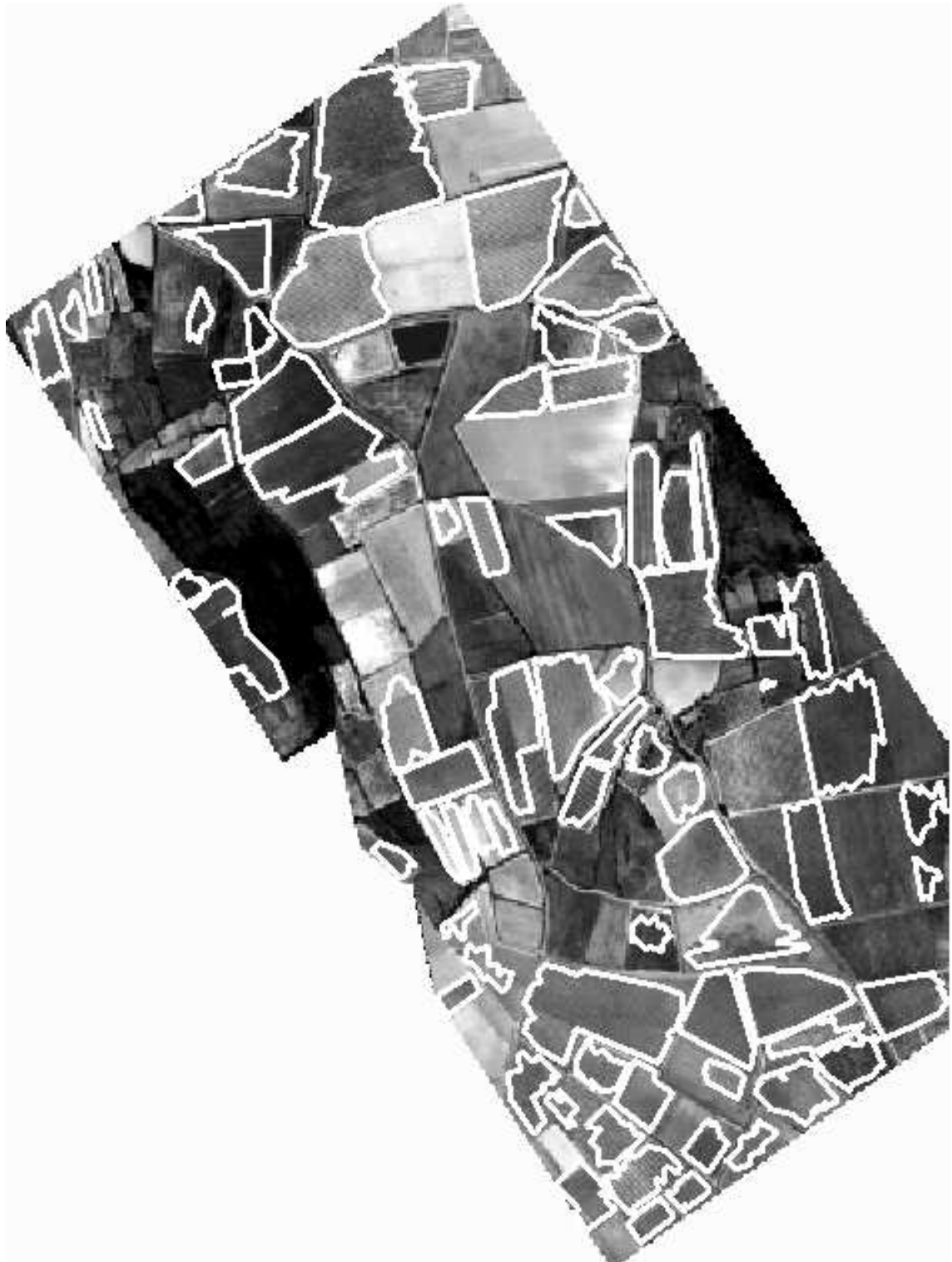
FIG. D.4: Résultats de segmentation par la méthode TFL après ajustement des rangs. Image juin 2005 - canal rouge - résolution 0,5 m - taille fenêtre 30 m.
