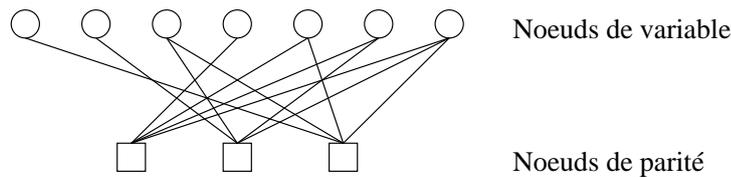
FIG. 12.4: Graphe bipartite représentant la matrice du code linéaire de Hamming (7, 4) (section 12.2). La représentation sous forme de graphe est nécessaire pour les codes LDPC car leur matrice  $H$  est trop grande pour qu'on puisse l'écrire.
