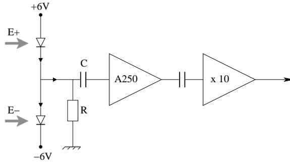
FIG. 7.2: Schéma électronique de la détection homodyne. Un amplificateur de charge amplifie la mesure de la charge accumulée par un condensateur. Cette charge est l'intégrale de la différence des photocourants issus des photodiodes. Une résistance permet de décharger le condensateur; un deuxième étage d'amplification permet de dériver le signal délivré par l'amplificateur de charge, et applique ensuite un gain de 10.
