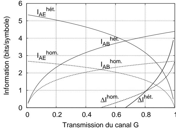
FIG. 3.5: Informations mutuelles pour une mesure hétérodyne en réconciliation directe (courbes pleines), pour  $V_A = 40N_0$  et  $\xi = 0$ . Comme pour la réconciliation inverse, ces informations sont comparées à celles obtenues avec une mesure homodyne (courbes pointillées). Les courbes grasses sont les informations secrètes.
