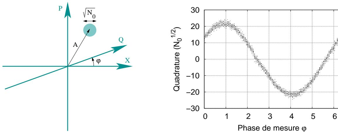
FIG. 6.2: Tomographie d'un état cohérent. En faisant varier la phase de mesure  $\phi$ , on observe la projection de l'état cohérent sur chaque quadrature  $Q$ . Dans cette figure, nous reconstituons la distribution de probabilité de la projection de l'état cohérent sur la phase de mesure en effectuant 18 mesures pour chacune des 100 phases choisies.
