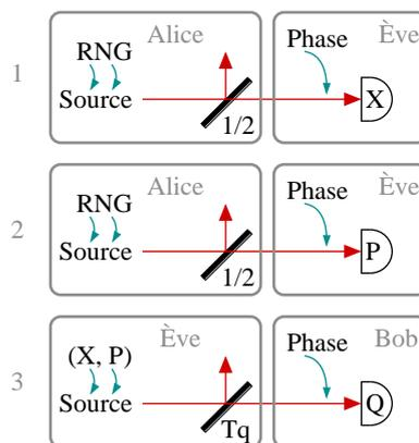
FIG. 8.2: Schéma de mise en œuvre de l'attaque interception-réémission. Afin d'éviter une réplication inutile de notre matériel, nous séparons l'attaque en trois parties : 1 – Ève mesure  $X$ . 2 – Ève mesure  $P$  sur une deuxième émission identique par Alice. 3 – Ève ré-émet un signal centré sur  $(X, P)$  sur un canal de transmission  $T_q$ . Bob mesure une quadrature aléatoire  $Q$  de ce signal.
