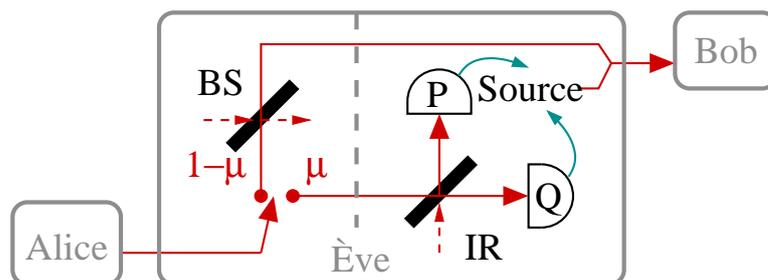
FIG. 8.4: Schéma d'une attaque interception-réémission partielle. Avec une probabilité  $\mu$ , Ève intercepte le signal envoyé par Alice et ré-émet un signal fonction de sa mesure. Sur les autres impulsions, Ève réalise une attaque lame séparatrice standard.
