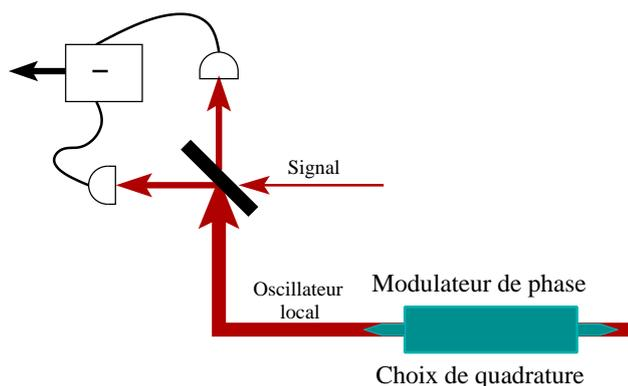
FIG. 6.1: Schéma de principe d'une détection homodyne.
