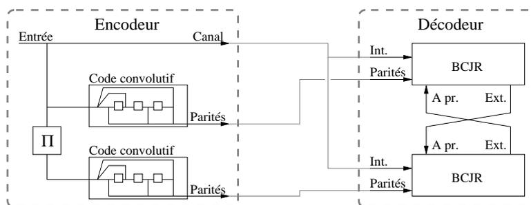
FIG. A.2: Concaténation parallèle de codes convolutifs (turbo codes). La chaîne de bits est encodée dans un ordre différent (interleaver  $\Pi$ ) par deux codes convolutifs identiques. Le décodage est un processus itératif, dans lequel l'information extrinsèque d'un décodeur sert d'information *a priori* pour l'autre décodeur (principe du «turbo»).
