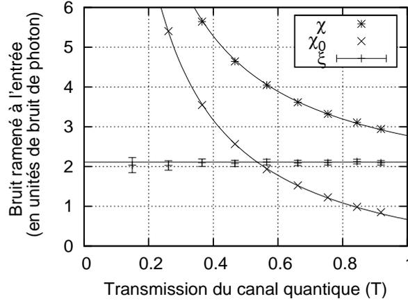
FIG. 8.3: Bruits ramenés à l'entrée entre Alice et Bob pour une attaque de type interception-réémission. Le bruit ajouté total est la somme du bruit ajouté dû aux pertes  $\chi_0 = \frac{1}{\eta T} - 1$  et du bruit en excès  $\xi = 2 + \xi_T$  où  $\xi_T \simeq 0,1$  est le bruit technique de l'expérience. On note  $\eta = 0,6$  l'efficacité de la détection homodyne.
