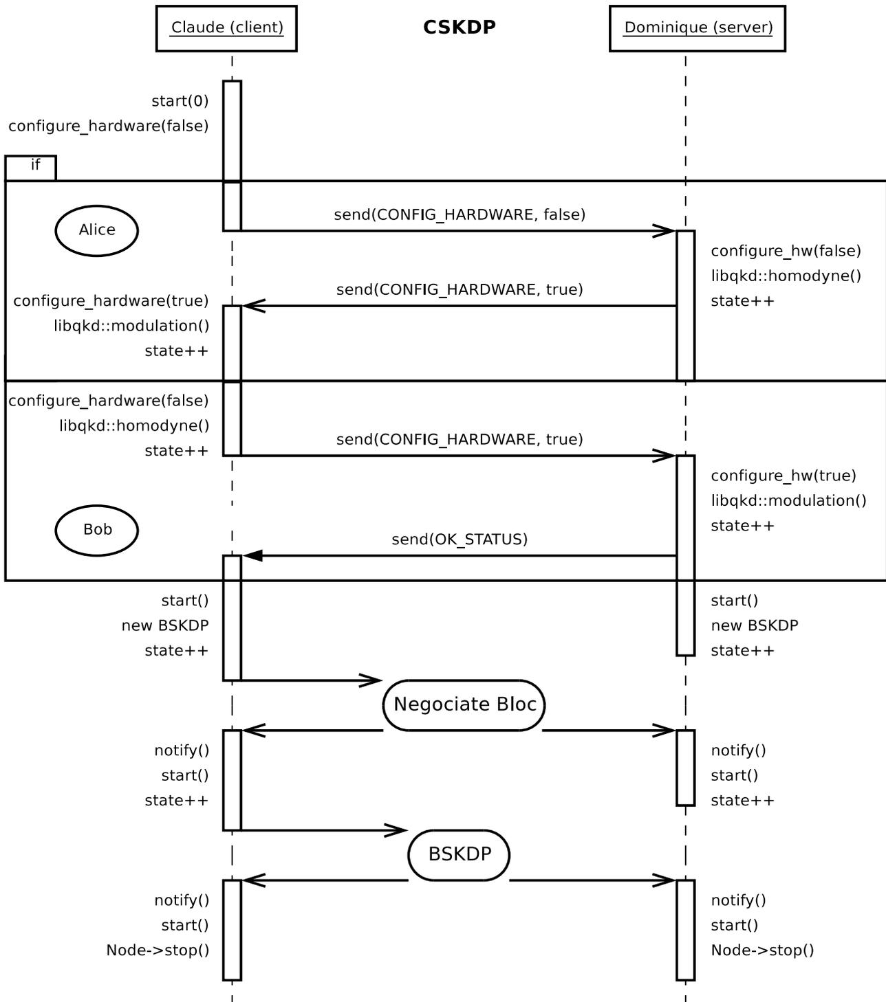
FIG. 15.1: Diagramme de séquence UML pour le protocole de communication CSKDP.
