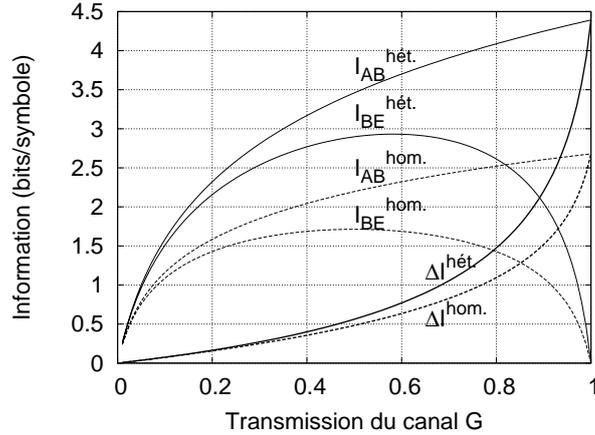
FIG. 3.2: Informations mutuelles pour une mesure hétérodyne en réconciliation inverse (courbes pleines), pour  $V_A = 40N_0$  et  $\xi = 0$ . Ces informations sont comparées à celles obtenues avec une mesure homodyne (courbes pointillées). Les courbes grasses sont les informations secrètes : la mesure hétérodyne produit davantage de bits secrets que la mesure homodyne.
