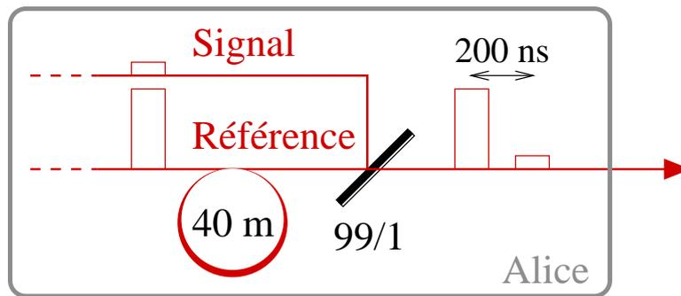
FIG. 9.1: Schéma de principe du multiplexage temporel. La référence de phase est décalée de 200 ns par rapport au signal. Les deux faisceaux sont injectés dans le canal quantique par un coupleur 99/1
