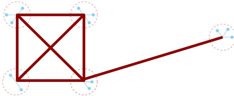
FIG. 10.5: Topologie du réseau quantique prévu par le projet SECOQC. 6 liens principaux ("Quantum Backbone") relient 4 nœuds répartis dans la ville de Vienne, à des distances variant entre 12 km et 35 km. Un lien externe de 80 km est également prévu. Éventuellement, d'autres liaisons fonctionnant à plus faible distance ("Quantum Access Network") peuvent se connecter au réseau principal. Des protocoles réseau sont en cours d'élaboration pour gérer les clés produites par chaque lien.
