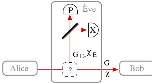
FIG. 3.3: Modèle d'attaque hétérodyne. Ève fait une mesure hétérodyne sur une copie du faisceau traversant le canal quantique. On note  $G_E$  et  $\chi_E$  les gain et bruit ajouté en entrée de sa mesure hétérodyne.
