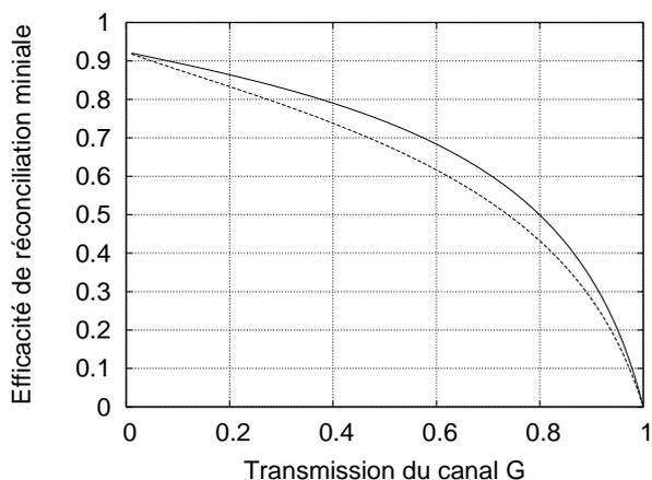
FIG. 3.7: Efficacité de réconciliation minimale pour extraire une clé secrète, en fonction de la distance, pour  $V_A = 12N_0$  et  $\xi = 0$ . Le protocole homodyne inverse (courbe pointillée) supporte davantage les faibles efficacités que le protocole hétérodyne inverse (courbe pleine).
