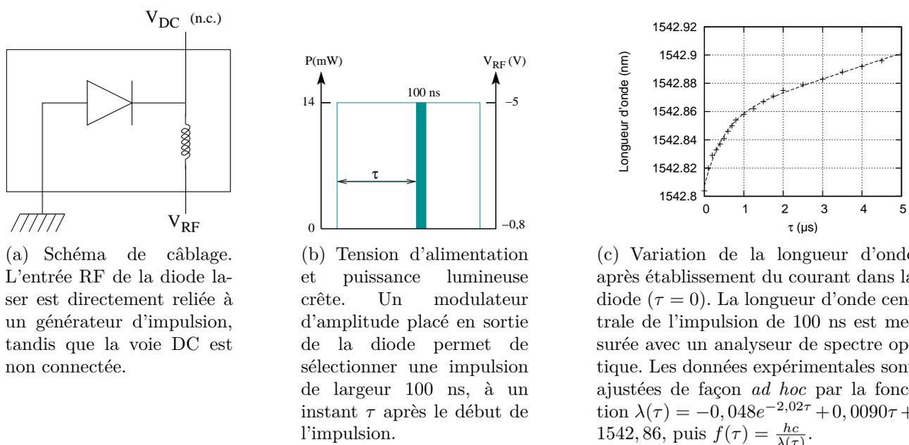
FIG. 9.3: Fonctionnement de la diode laser pulsée AL1905LMI
