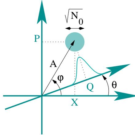
FIG. 2.1: Espace des phases dans lequel on repère un mode du champ électromagnétique par ses quadratures  $X$  et  $P$ , ou toute quadrature  $Q_\theta$ . La quantification des variables de quadrature conduit à une zone d'incertitude de variance  $N_0$  autour de la valeur classique d'une mesure de quadrature, appelée «bruit de photon».
