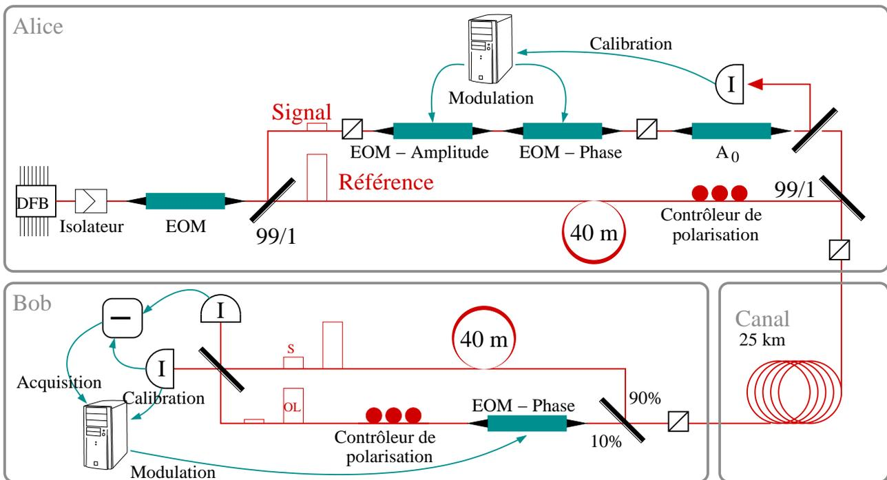
FIG. 5.1: Schéma expérimental montrant chaque sous-système de l'expérience.
