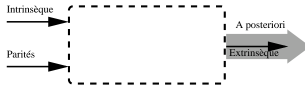
FIG. 12.3: On peut représenter un décodeur mou comme une boîte noire caractérisée par ses entrées et sorties. En entrée, on trouve les informations intrinsèque (apportée par la mesure du canal) et les parités (la redondance introduite à l'encodage). En sortie, on obtient l'information a posteriori , c'est-à-dire une connaissance améliorée de la chaîne de bits encodée, dont l'apport original du décodage est l'information extrinsèque.
