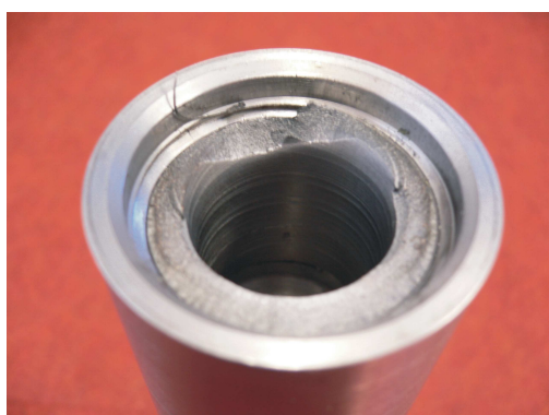
FIG. 5.10 – Photographie d'une connexion à échelle réduite rompue au niveau du fond de filet du LET de la partie mâle
