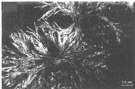
Figure B.53 - Sphérolites de cis-polyisoprène cristallisés dans des films minces à -12^{\circ}\text{C} pendant 19 h.
