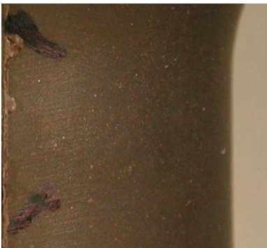
Figure C.63 – Deux directions indépendantes de fissuration correspondant aux deux position extrêmes du chargement alterné. Chargement ( -100^\circ , 100^\circ ), matériau BII
