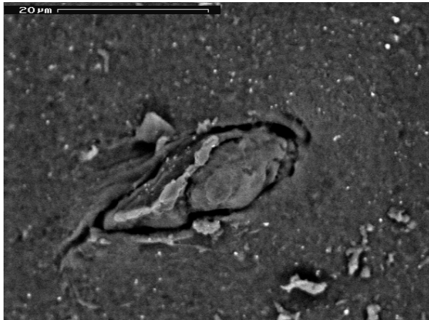
Figure B.111 – Dislocation d'un agglomérat de silice et de gomme liée (Si-PI-Si) à un taux de déformation autour de 20%.
