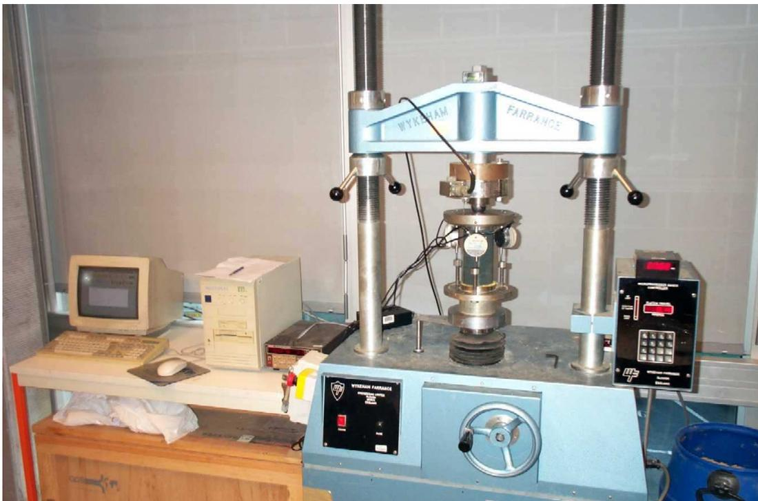
FIG. 2.15: *Vue du dispositif de compression uniaxiale*
