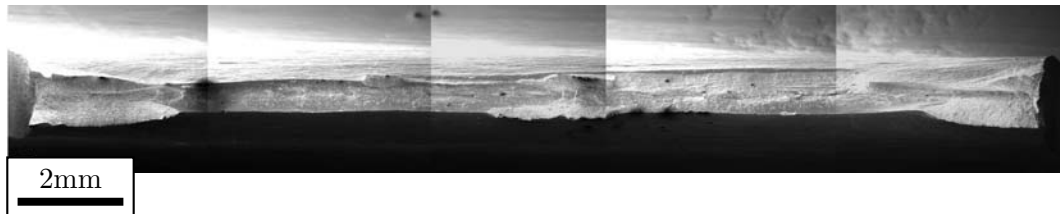
Figure III.13 : Macro-fractographie d'une éprouvette de déformation plane en traction T (acier P1).
