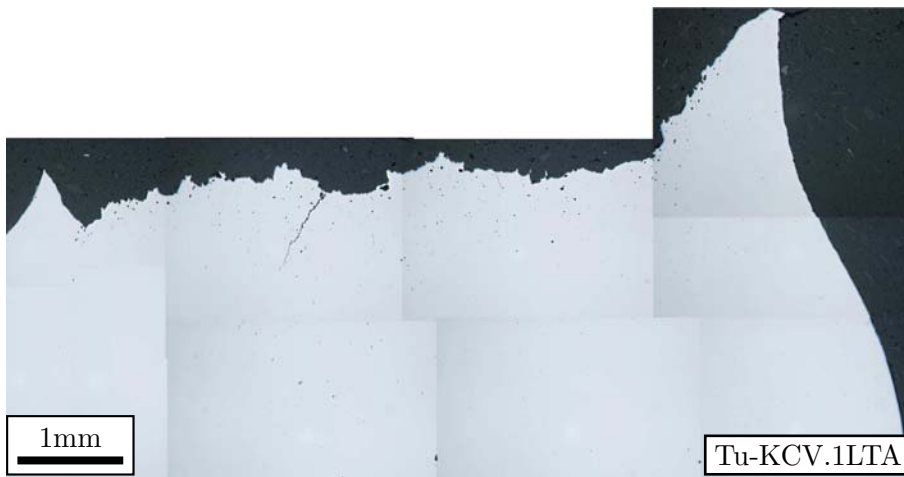
Figure III.38 : Microscopie sur surface polie non attaquée. Coupe transversales des éprouvettes Charpy V (aciers P1 et Tu).
