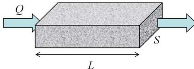
FIG. 1.16 – Bloc poreux soumis à un écoulement.
