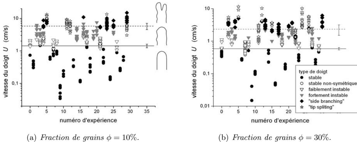
FIG. 3.25 – Diagramme de stabilité : typologie des doigts observés selon les expériences et la vitesse pour des suspensions d'huile SE KF-6011 et de billes de  $80\ \mu\text{m}$  dans une géométrie de cellule  $W = 4\ \text{cm}$ ,  $b = 1.43\ \text{mm}$ . La ligne pleine représente la moyenne des valeurs de transition d'un doigt stable à un doigt instable, la ligne en tirets celle d'un doigt instable aux phénomènes de "side branching" ou de "tip-splitting".
