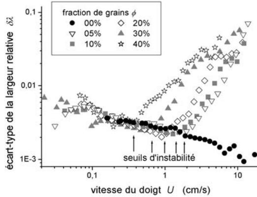
FIG. 3.27 – Écart-type moyen  $\delta\lambda$  de la largeur relative des doigts en fonction de la vitesse  $U$  du doigt pour des suspensions d'huile SE KF-6011 et de billes de  $80\ \mu\text{m}$  dans une géométrie de cellule  $W = 4\ \text{cm}$ ,  $b = 1.43\ \text{mm}$ . Les flèches indiquent les seuils d'instabilité repérés pour les différentes fractions de grains.
