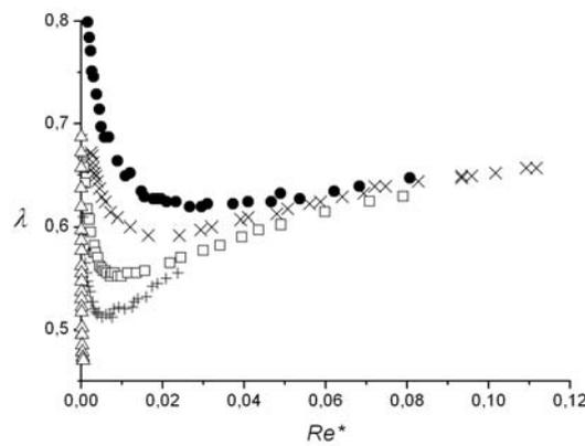
FIG. 2.4 – Largeur relative des doigts  $\lambda$  en fonction du nombre de Reynolds modifié  $Re^*$  pour une géométrie donnée de cellule  $b = 0.75$  mm  $W = 4$  cm et différents fluides : ●, V02; ×, V05; □, V10; +, V20; △, V100.
