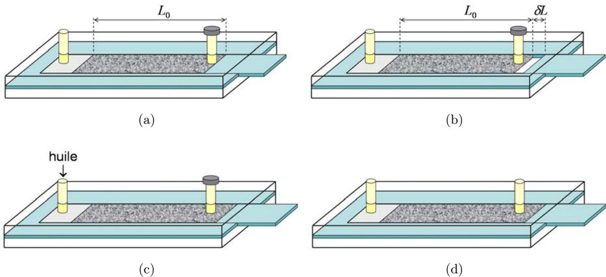
FIG. 5.1 – Schéma du protocole de décompaction. (a) Le milieu imbibé est préparé exactement comme décrit figures 4.1(a,b,c). Il existe une entrée supplémentaire initialement bouchée. (b) Le bouchon de Mylar est déplacé d'une distance  $\delta L$  laissant un espace vide. (c) Le milieu est décompacté progressivement. (d) Une fois la décompaction réalisée, le bouchon de Mylar est maintenu et la seconde entrée dans la cellule est libérée.
