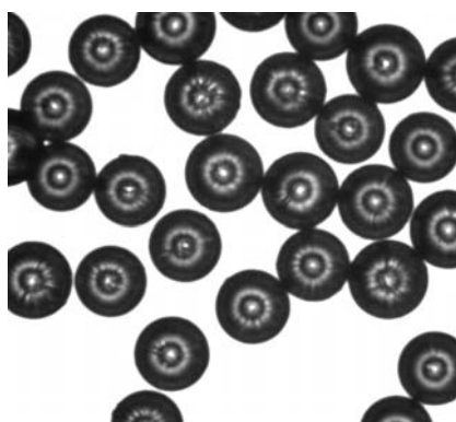
FIG. 3.1 – Photographie des billes de polystyrène de diamètre 80 \mu\text{m} .
