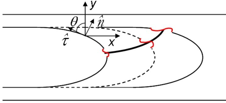
FIG. 3.29 – Schéma de l'advection d'une perturbation le long d'un doigt de Saffman-Taylor lorsque celui-ci avance dans la cellule. D'après Bensimon et al. [13].
