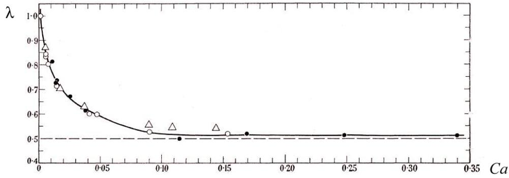
FIG. 1.12 – Largeur relative des doigts  $\lambda$  obtenue pour différents fluides dans une seule géométrie de cellule de Hele-Shaw en fonction du nombre capillaire  $Ca$  d’après les expériences de Saffman et Taylor [92].
