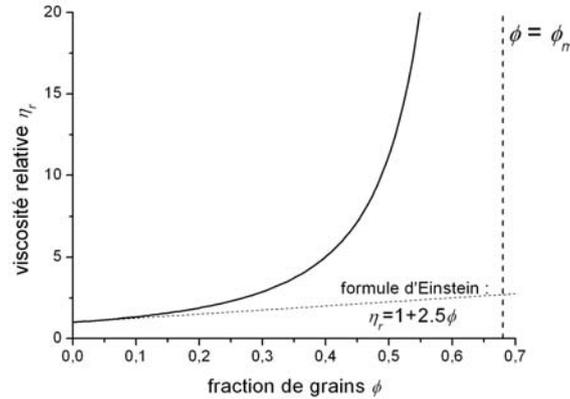
FIG. 1.2 – Modèle de viscosité relative  $\eta_r$  de Krieger–Dougherty [56, 57] en fonction de la fraction de grains  $\phi$ . Les deux lignes en tirets représentent la limite aux faibles fractions de grains (loi d’Einstein) ainsi que l’asymptote  $\phi = \phi_m$ .
