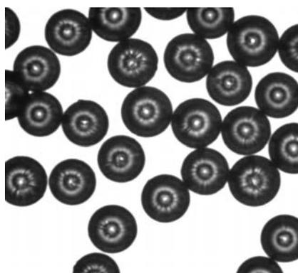
FIG. 3.1 – Photographie des billes de polystyrène de diamètre 80  $\mu\text{m}$ .
