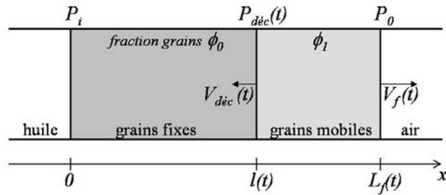
FIG. 4.7 – Schéma du processus de décompaction.
