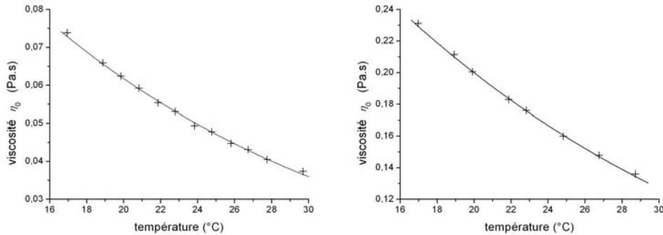
FIG. 3.4 – Viscosité des fluides purs DC 704 (à gauche) et SE KF-6011 (à droite) en fonction de la température, points expérimentaux (+) et ajustement (ligne pleine).
