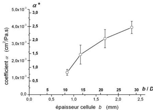
FIG. 4.15 – Coefficient  $\alpha$  moyennée en fonction de l'épaisseur de cellule  $b$  et du rapport de cette dernière avec le diamètre  $D$  des grains. Le coefficient  $\alpha^*$  est la valeur de  $\alpha$  adimensionnée par  $\alpha_0$  (4.18).
