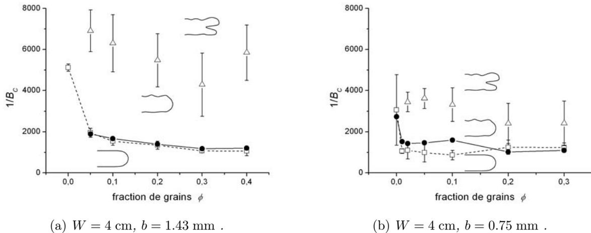
FIG. 3.28 – Paramètres de contrôle critiques en fonction de la fraction de grains (suspensions d'huile SE KF-6011 et de billes de  $80 \mu\text{m}$ ) pour deux configurations différentes : ●, transition stable/instable déterminée par la variation de l'écart-type ; □, transition stable/instable déterminée visuellement ; Δ, transition instable/"tip-splitting" déterminée visuellement.
