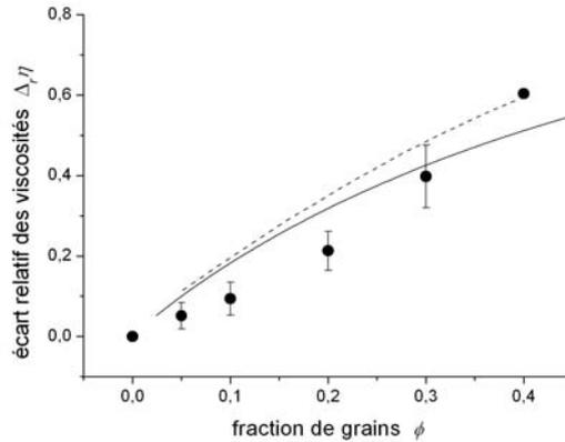
FIG. 3.20 – Écart relatif des viscosités  $\Delta_r \eta$  en fonction de la fraction de grains  $\phi$  : points expérimentaux (●) et valeurs déduites du modèle de Phillips et al. avec viscosité du type Krieger–Dougherty (courbe pleine) ou avec viscosité du type Zarraga et al. (courbe en tirets).
