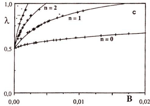
FIG. 1.13 – Familles discrètes de largeur relative  $\lambda_n$  sélectionnées par la tension de surface pour  $n = 0, 1$  et  $2$  en fonction de  $B$  d'après [26]. La solution pour  $n = 0$  est stable et correspond aux doigts observés expérimentalement.
