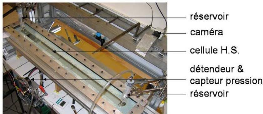
FIG. 3.8 – Photographie du dispositif expérimental.
