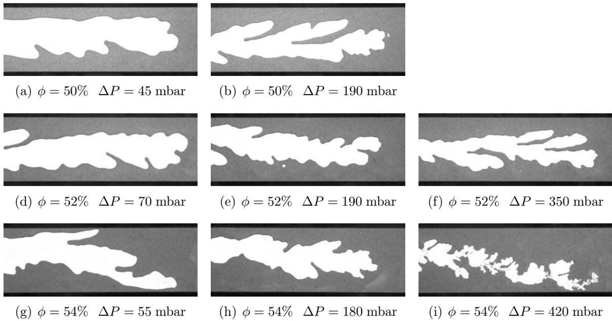
FIG. 3.37 – Motifs de digitation observés lors de l'injection d'air dans des suspensions à base d'huile SE KF-6011 et de billes de 80  $\mu\text{m}$  pour une géométrie de cellule  $W = 4\text{ cm}$   $b = 0.75\text{ mm}$  et pour différentes fractions de grains  $\phi$  et surpressions appliquées  $\Delta P$ . L'injection se fait de gauche à droite.
