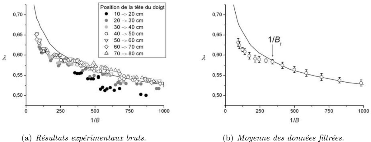
FIG. 3.34 – Largeur relative des doigts  $\lambda$  en fonction du paramètre de contrôle  $1/B$  pour une suspension d'huile SE KF-6011 à une fraction de  $\phi = 20\%$  de billes de  $80 \mu\text{m}$  dans une géométrie de cellule  $W = 4 \text{ cm}$ ,  $b = 1.43 \text{ mm}$ . La courbe pleine représente la courbe maîtresse de la digitation de Saffman–Taylor dans cette géométrie. Le paramètre de contrôle de transition  $1/B_t$  est localisé sur la figure (b).
