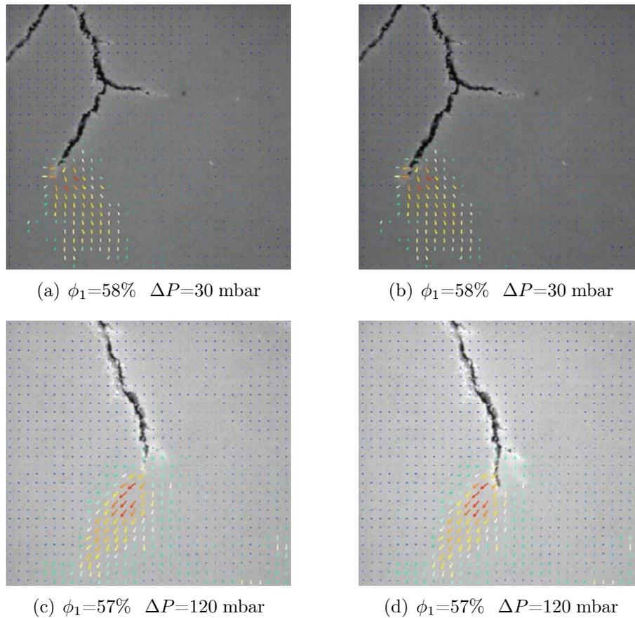
FIG. 5.8 – *Champs de déplacement extraits par le logiciel de corrélation d'images (CIV) entre les images (a) et (b) et entre les images (c) et (d). Norme des vecteurs déplacements multipliée par un facteur 4 (images a,b) ou 3 (images c,d), origine conservée. Épaisseur de cellule  $b = 2.30$  mm.*
