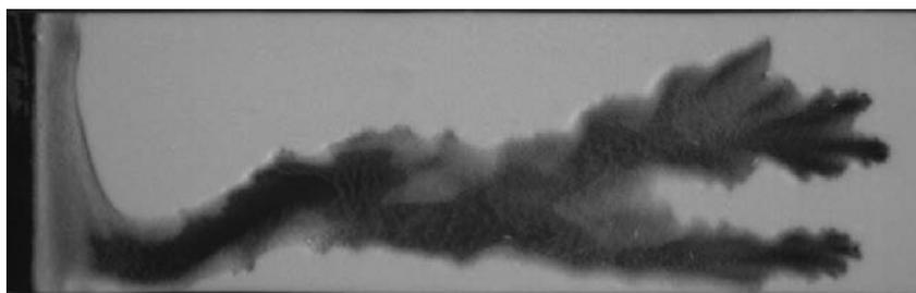
FIG. 4.26 – *Digitation obtenue dans un système air/milieu granulaire sec d'après Johnsen et al. [communication privée]. Géométrie de cellule  $W = 6$  cm  $b = 1.08$  mm, taille des grains  $D = 80$   $\mu$ m, surpression d'air  $\Delta P = 14$  mbar.*
