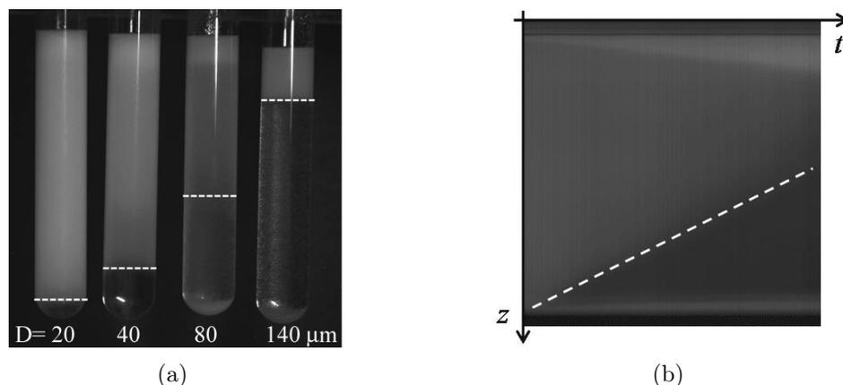
FIG. 3.5 – Étude de la "flottabilité" des suspensions. (a) Vue d'ensemble des tubes au bout de 48 heures. (b) Diagramme spatio-temporel pour la suspension composée de grains de  $80 \text{ }\mu\text{m}$  de diamètre. L'axe des temps s'étale sur une durée d'environ 65 heures. En tirets blancs, l'évolution quasi-linéaire du front de flottabilité.
