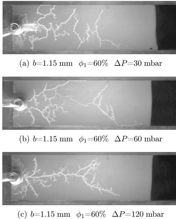
FIG. 5.3 – Évolution des motifs d’injection en fonction de la surpression appliquée  $\Delta P$  pour un milieu non décompacté ( $\phi_1 = 60\%$ ,  $\delta L = 0.0 \text{ mm}$ ) et pour une épaisseur de cellule  $b = 1.15 \text{ mm}$ .
