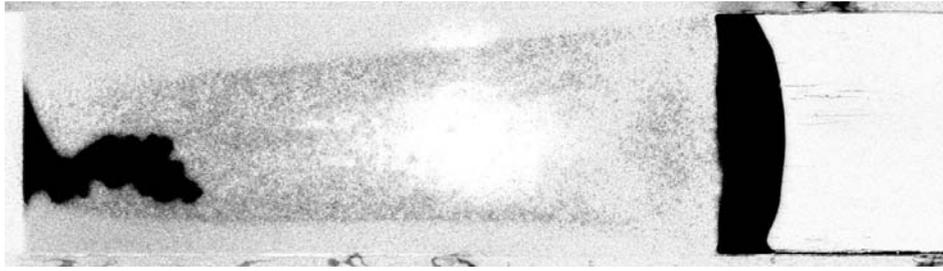
FIG. 4.19 – *Allure du canal d'écoulement : figure 4.4(j) au contraste accentué. La zone blanche au centre du canal correspond à une saturation de luminosité sur l'image d'origine. Il s'agit d'un artefact et elle devrait être sombre.*
