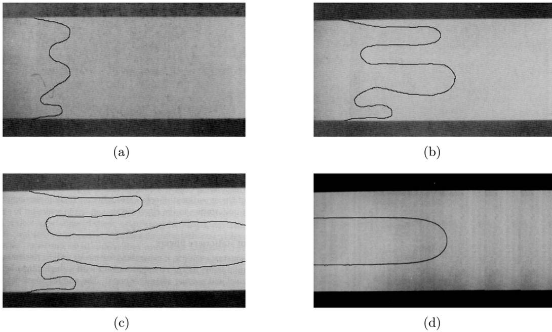
FIG. 1.11 – Evolution de l’interface entre les deux fluides en cellule de Hele-Shaw d’après Tabeling et al. [100]. (a) Au premier stade de l’instabilité des bosses de taille caractéristique  $l_c$  déforment l’interface. (b,c) Rapidement la compétition entre ces bosses conduit à la sélection d’un seul doigt. (d) Ce doigt est caractérisé par sa largeur relative  $\lambda$  en fonction de sa vitesse  $U$ .
