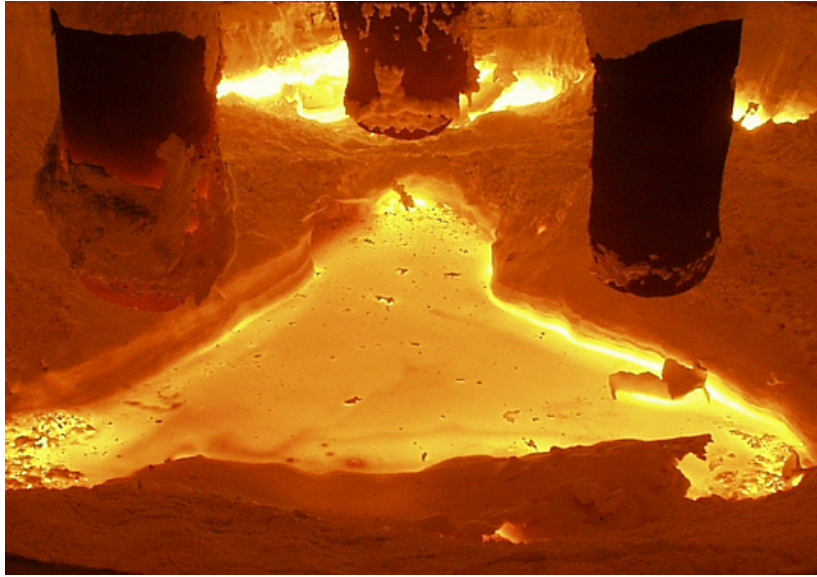
Fig. I.3 – Électrodes d'un four à arc plongeant dans le bain en fusion.
