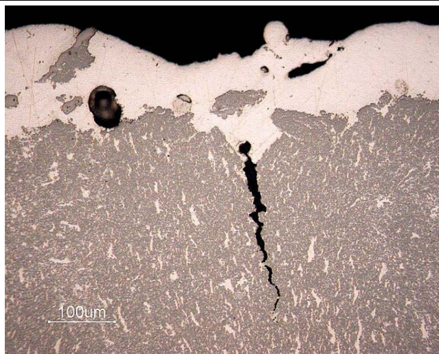
Micrographie optique 3.29. Fissure de fatigue sur un contact mobile Ag-WC ayant subi 10 000 manœuvres
