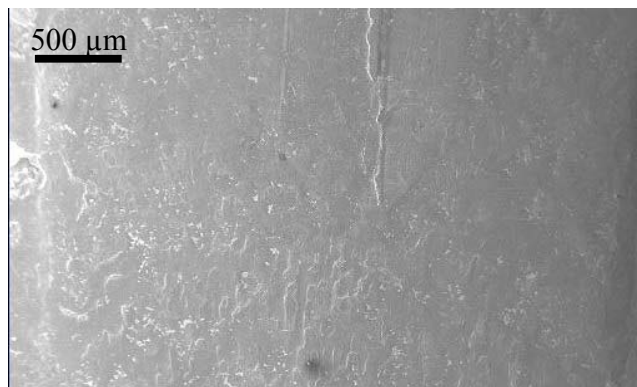
Micrographie MEB 3.9. Etat de surface d'un contact en Ag-WC n'ayant pas subi d'essai Contact mobile. Cliché MEB Leo en électrons secondaires
