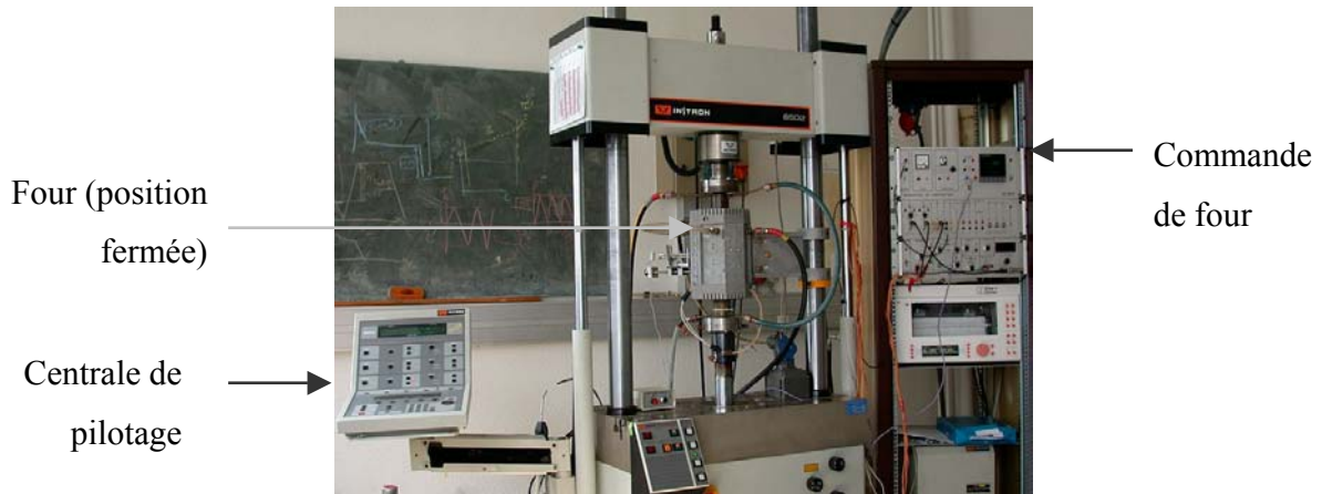
Photographie 4.7. Machine d'essai INSTRON 8502 Hydraulique
