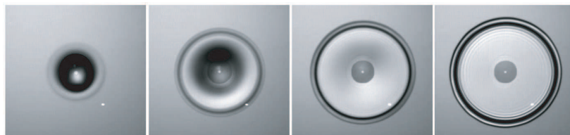
FIG. 5.32: Vue aérienne d'un impact de goutte d'eau lâchée de 20 cm de haut ( V = 1.9 m/s, R_0 = 1.9 mm, p = 10 \mu\text{m} , h = 18 \mu\text{m} ). Les images sont espacées de 1 ms. La goutte s'étend de manière isotrope sans qu'il n'y ait de fragmentation du bourrelet.
