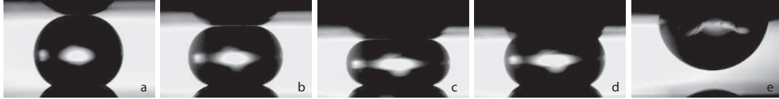
FIG. 3.14: Expérience de compression d'une goutte d'eau millimétrique entre une surface "fragile" illustrée sur la figure 3.12b et une surface très rugueuse sur laquelle l'état "fakir" est l'état stable. La goutte, initialement posée sur la surface rugueuse, s'enfonce dans la surface "fragile" lorsque sa pression interne vaut 215 Pa.
