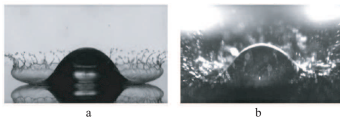
FIG. 5.29: Vue de côté d'impacts de gouttes d'éthanol sur surface lisse (a) et rugueuse (b). Dans le premier cas, il y a formation d'une couronne liquide qui se déstabilise en gouttelettes alors que dans le deuxième cas, la déstabilisation apparaît avec l'avancée de la feuille liquide sur la surface rugueuse.
