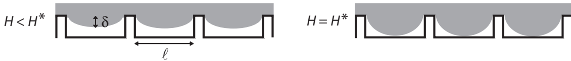
FIG. 5.14: Schéma de l'interface eau-air sous la goutte à faible vitesse d'impact ( H < H^* ) et à forte vitesse d'impact ( H \geq H^* ).
