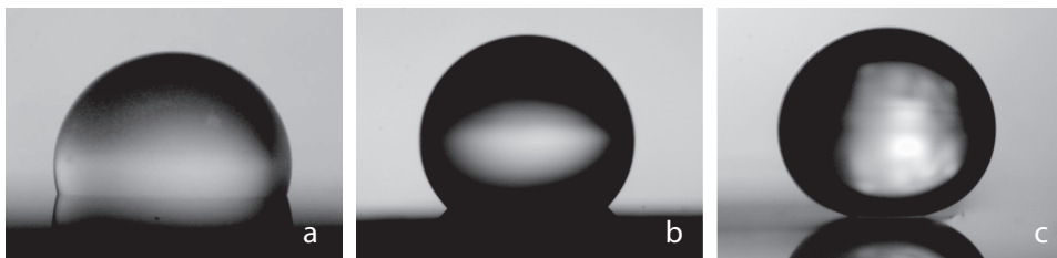
FIG. 3.1: Gouttes d'eau millimétriques posées sur : (a) une surface lisse hydrophobe ( \theta_{e_a} = 100 \pm 2^\circ ), (b) sur une surface texturée d'une densité surfacique de plots de 26% ( \theta_{e_b} = 129 \pm 2^\circ ) et (c) sur une surface texturée d'une densité surfacique de plots de 1% ( \theta_{e_c} = 160 \pm 2^\circ ). On observe que l'angle de contact augmente lorsque la densité surfacique de plots diminue, ce que l'on interprète comme résulter d'un état "fakir".
