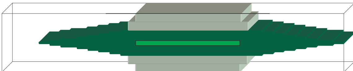
Figure III. 12 : Le schéma expérimental d'un applicateur rempli par trois diélectriques
