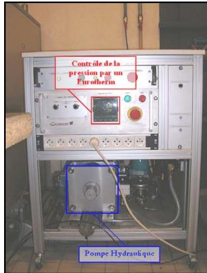
Figure 6.11 - Dispositif de mise en pression des réservoirs
