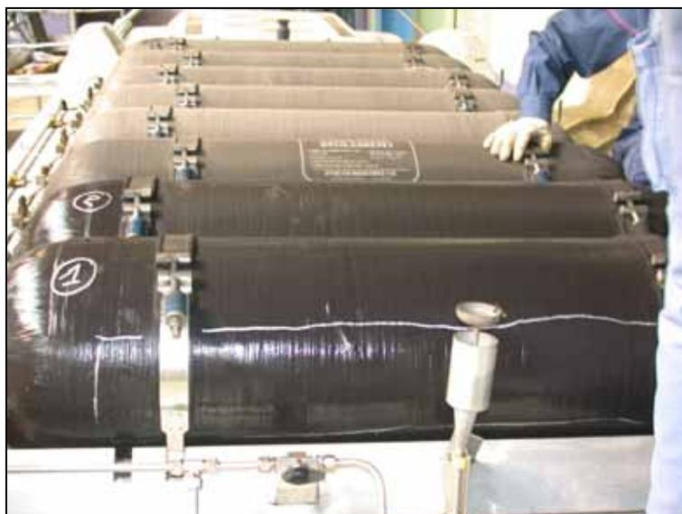
Figure 3.1 - Réservoirs G.N.V. positionnés sur le toit d'un bus
