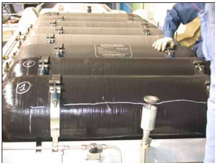
Figure 3.1 - Réservoirs G.N.V. positionnés sur le toit d'un bus
