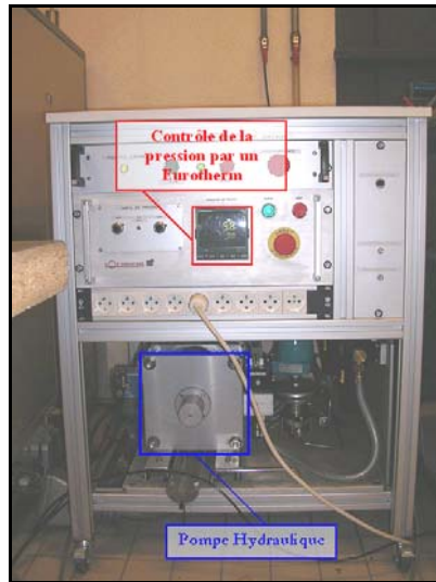
Figure 6.11 - Dispositif de mise en pression des réservoirs
