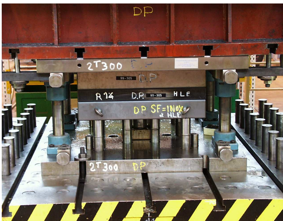
FIG. 168 – Photos de la presse et du montage d'emboutissage avec l'outil en croix
