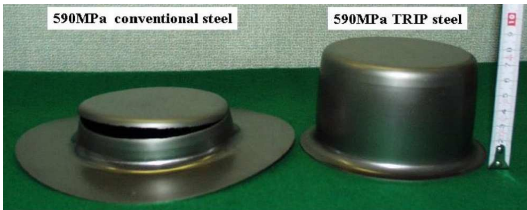
FIG. 126 – Emboutis Marciniak : comparaison de l'emboutissabilité entre un acier HLE et un acier TRIP [TYH02]
