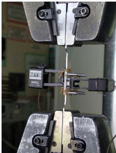
Figure 2.3: Montage pour les essais de traction
