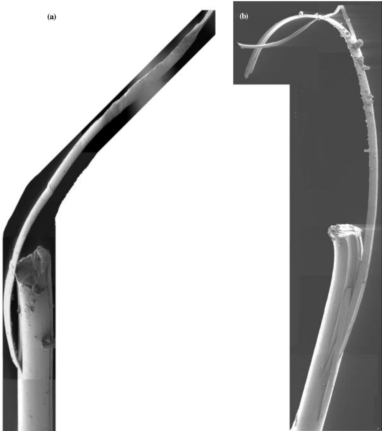
**Fig. 4.40** Faciès de rupture en fatigue des fibres PET-B testées à 0-80%  $S_R$  et rompues après (a) 327600 cycles (1.82 h) et (b) 736200 cycles (4.09 h).
