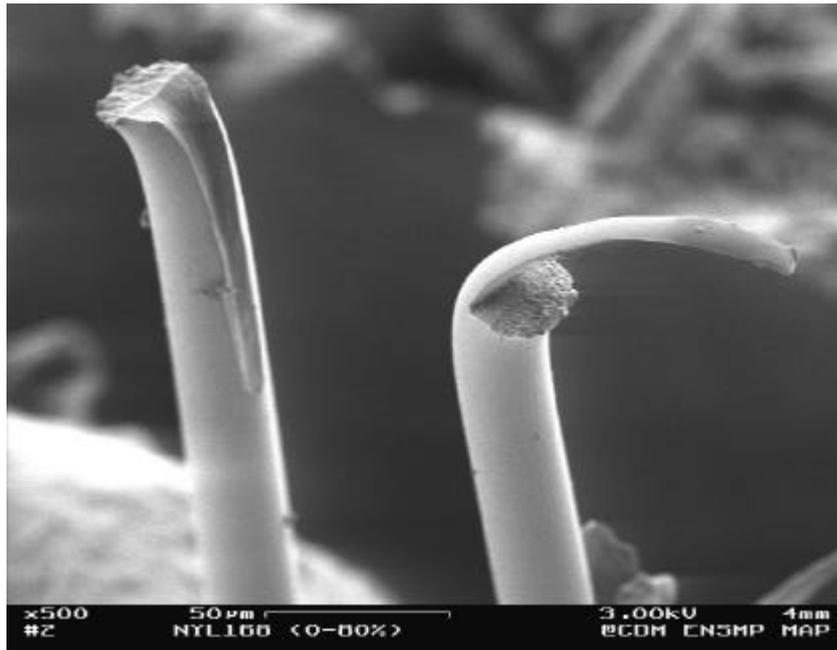
**Fig. 4.22** *Faciès de rupture complémentaires d'une fibre PA66-A, obtenus après une rupture en fatigue.*
