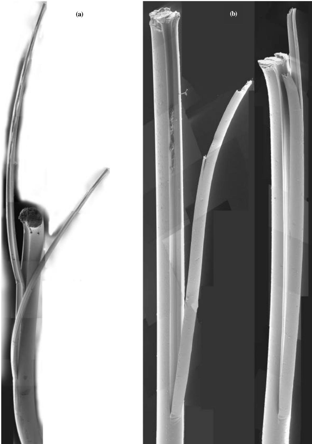
**Fig. 4.35** Faciès de rupture des fibres PET-A testées à (a) 0-90%  $s_R$  ( $N = 171000$ , 0.95 h) et (b) 5-85%  $s_R$  ( $N = 11.1 \times 10^6$ , 61.67 h).
