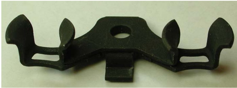
Fig. B.6 – Solution technique apportée aux problèmes de rupture par fatigue thermomécanique : insert métallique faisant office de crack stopper. Après usinage de la face feu, il ne reste que les quatre bords relevés insérés entre les sièges de soupapes, dans les pontets.
