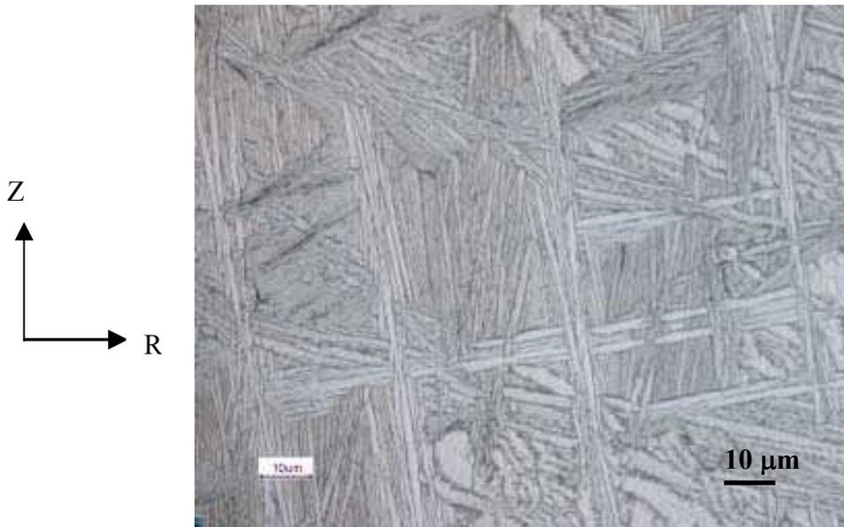
**Figure IV-21.** Micrographie d'un échantillon après un essai de fluage à 1100 °C (1 heure), (même conditions d'observation).
