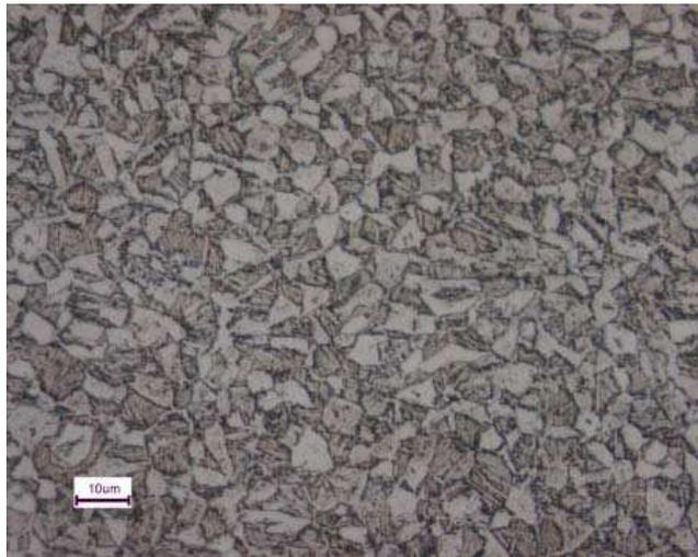
**Figure IV-59.** Micrographie de l'échantillon traité à  $865 \text{ }^\circ\text{C}$  pendant 30 min puis trempé four coupé ( $\% \beta = 47$ ).
