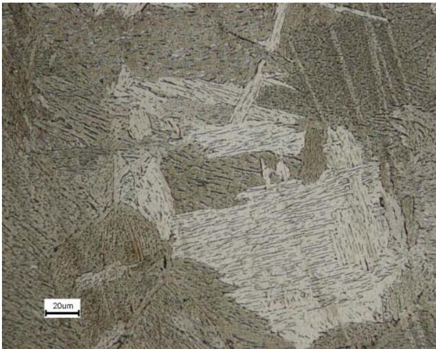
**Figure IV-52.** Microstructure après fluage à 760 °C après T.T
