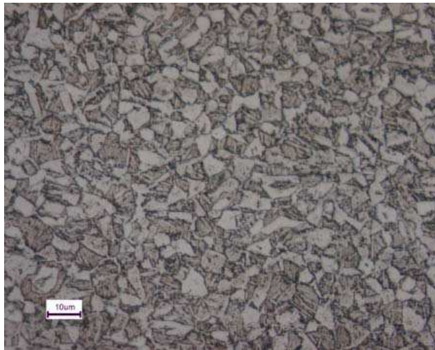
Figure IV-59. Micrographie de l'échantillon traité à 865 \text{ }^\circ\text{C} pendant 30 min puis trempé four coupé ( \% \beta = 47 ).
