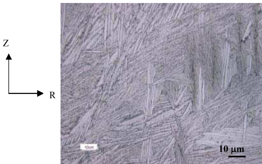
Figure IV-20. Micrographie d'un échantillon après un essai de fluage à 960 °C (2 heures), (phase \alpha en clair, \beta résiduelle en foncé, attaque1, microscopie optique).
