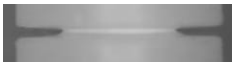
Figure III.11 Observation d'une éprouvette AE0.15 avant microtomie, après essai interrompu réalisé à 20°C et 0.15 mm/s
