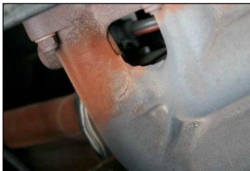
figure 3.55 : Exemple de fissuration d'un collecteur au pontage de deux tubes d'échappement
