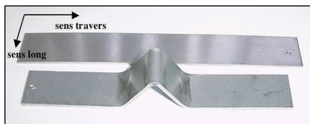
figure 1.3 : Eprouvette de fatigue thermique avant et après mise en forme
