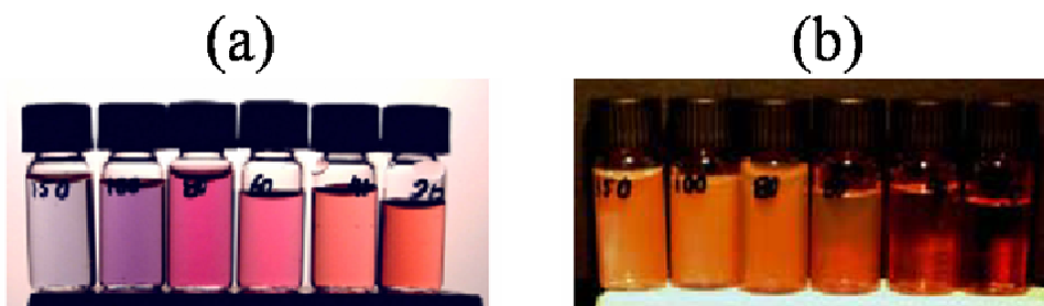
FIG. 1.7: Photographie en lumière blanche, en transmission (a) et en réflexion (b), de solutions colloïdales contenant des nanoparticules sphériques de différentes tailles. Le rayon moyen des nanoparticules est, en prenant les flacons de gauche à droite : 150 / 100 / 80 / 60 / 40 / 20 nm. La teinte des solutions colloïdales d'or (en transmission) passe du bleu au rouge lorsque la taille des particules diminue (Liz-Marzán 2004).
