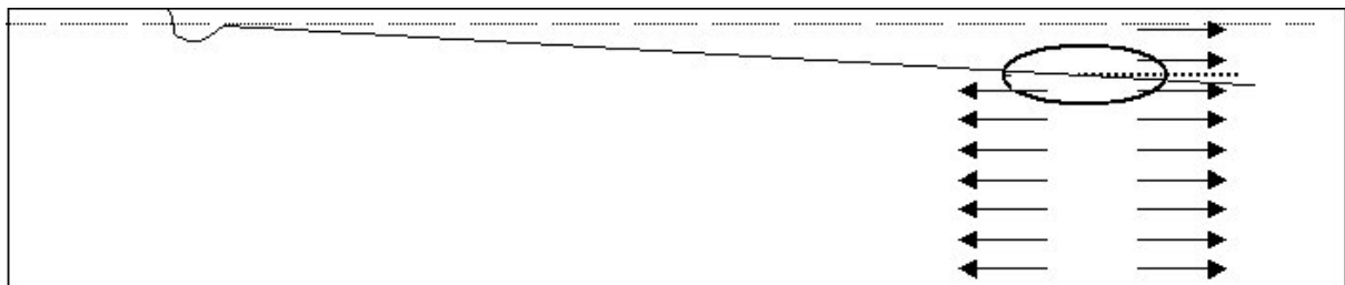
Figure 6-21 Schéma présentant la dissymétrie des forces au fond de la fissure longitudinale, lors de la fatigue.
