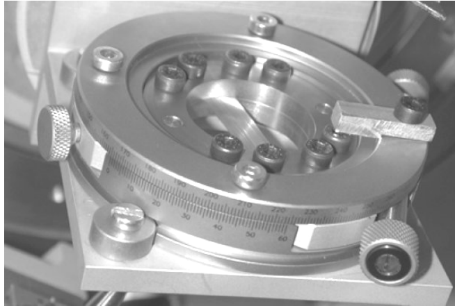
Figure 2-14 Montage utilisé pour régler la position en \varphi des fibres avec la précision du vernier de 0.01^\circ
