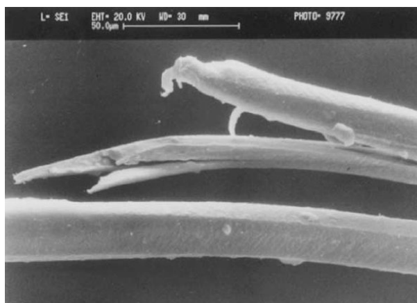
Figure 1-28 Faciès de fibre extraite de mèche rompue après un essai de disque de fatigue de Goodrich [NAS04].
