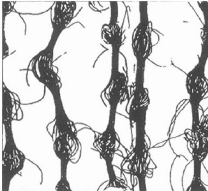
Figure 1-15 Modèle fibrillaire de Statton à cordes ou faisceaux de macromolécules [STA59].
