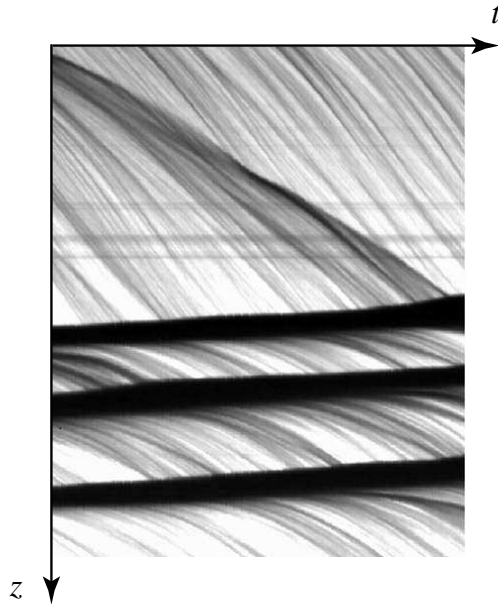
FIG. 2.4 – Diagramme spatio-temporel du régime d'ondes de densité réalisé pendant la phase transitoire de remplissage du tube. Une zone de chute libre est observée dans la partie supérieure du tube alors que des ondes légèrement ascendantes sont présentes plus bas.
