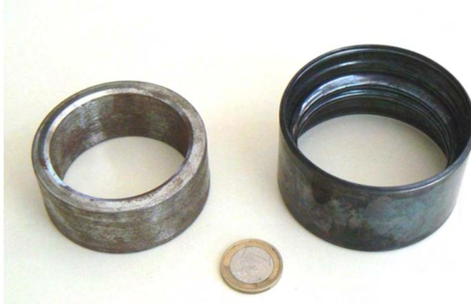
figure 2-2: lopin initial (gauche) et bague finale (droite)
