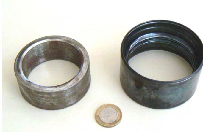
figure 2-2: lopin initial (gauche) et bague finale (droite)
