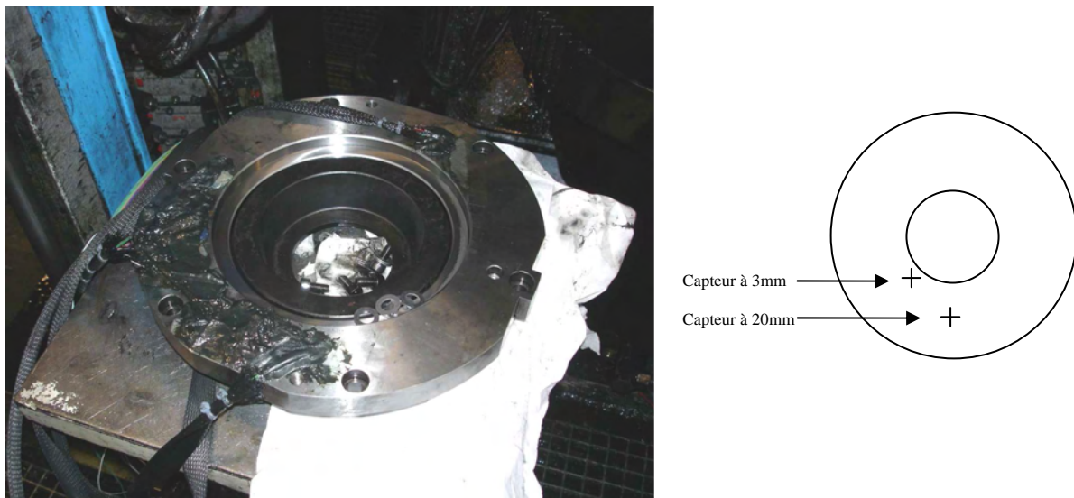
figure 2-9: matrice instrumentée et schéma d'implantation des thermocouples
