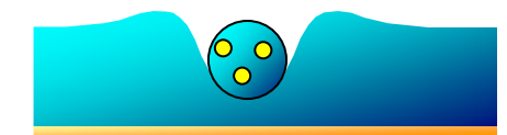
Figure n° 3.10 : La goutte d'émulsion traverse sans problème le film d'eau présent, au risque d'altérer le film d'huile déjà adsorbé sur la tôle.
