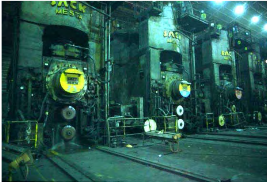
Figure n°0.1 : train de laminage. La tôle est progressivement réduite en épaisseur par passage de celle-ci dans les différentes cages constitutives du train.
