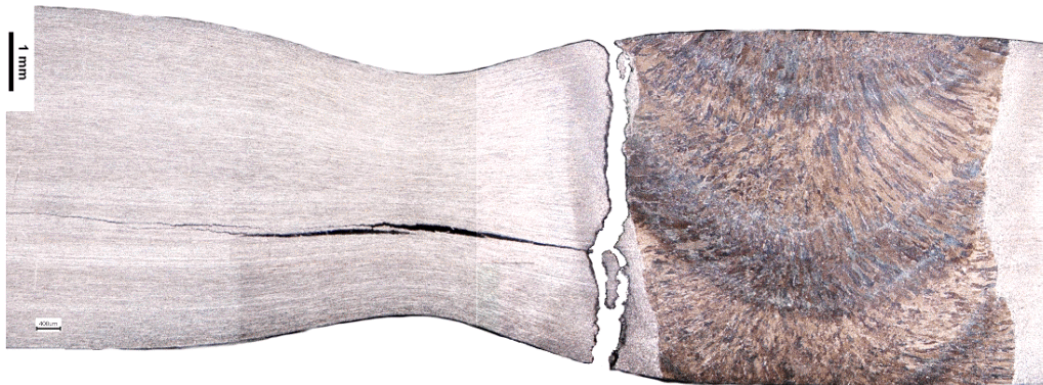
Figure III-11 : Striction à \sim\text{FL}+2\text{ mm} , mais rupture dans la ZAT C à -196\text{ }^{\circ}\text{C}
