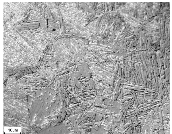
Figure III-15 : Microstructures peu déformées des ZAT C de l'éprouvette de traction après essai à -196 °C
