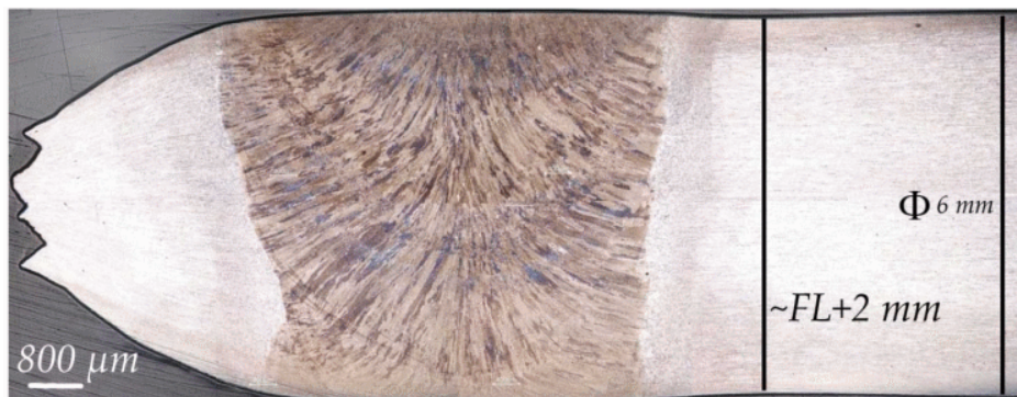
Figure III-9 : Striction et rupture à ~FL+2 mm à 20 °C
