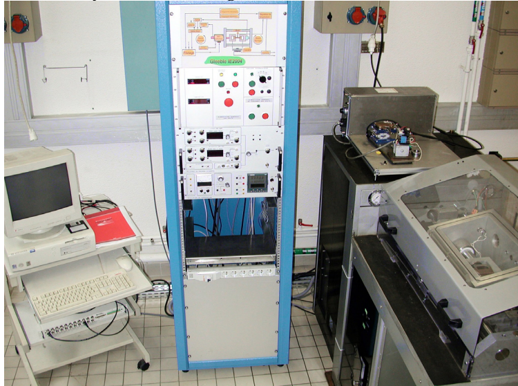
Figure IV-8 : Simulateur thermomécanique Gleeble et son rack de contrôle et d'acquisition
