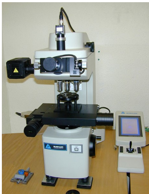
Fig. C-23 : Microduromètre Buehler micromet 5114 semi-automatique
