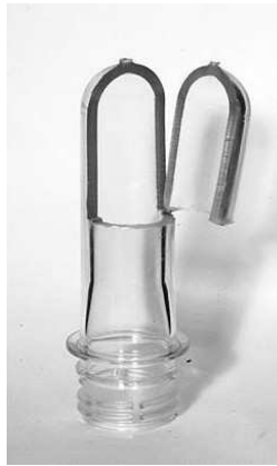
figure III-25 : préforme découpée pour les mesures de gradients thermiques cœur/peau
