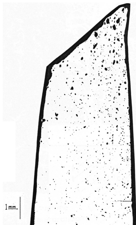
FIG. 1.38 : Observation d'un endommagement intergranulaire généralisé sur une éprouvette de fatigue-relaxation sur un acier VIRGO à 600°C [Levaillant, 1984].
