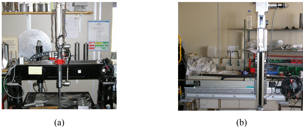
Figure 3.13 – (a) Pénétrömètre hydraulique utilisé pour l'exécution de l'essai sous force verticale centrée (b) Pénétrömètre électrique pour la détermination du profil de cohésion du sol.
