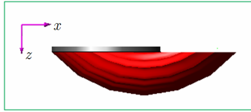
Figure 2.73. Le mécanisme tridimensionnel purement rotationnel sans décollement.
