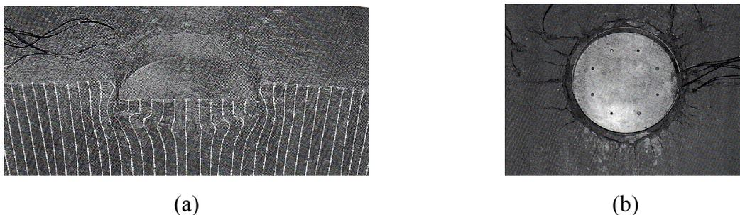
Figure 2.20 – Résultats typiques des tests en centrifugeuse d'après Tani & Craig (1995) ; a) déformation du sol argileux, b) surface du sol
