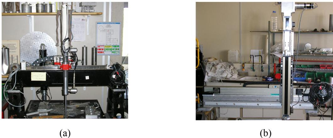
Figure 3.13 – (a) Pénétrömètre hydraulique utilisé pour l'exécution de l'essai sous force verticale centrée (b) Pénétrömètre électrique pour la détermination du profil de cohésion du sol.
