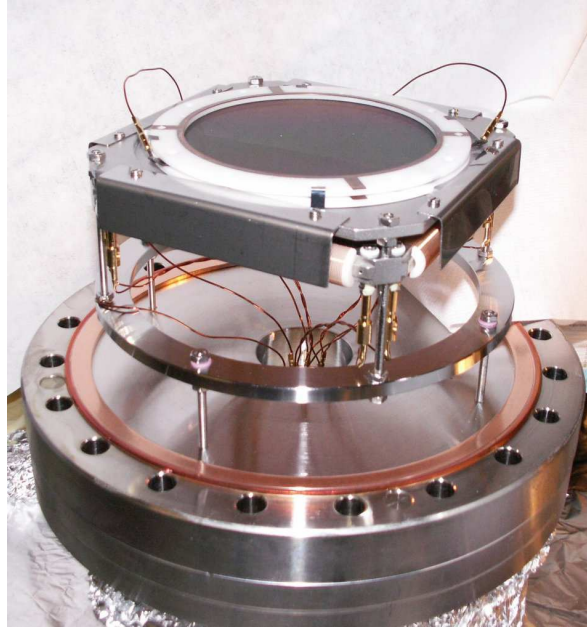
FIG. 2.11 – Vue du montage expérimental. Les MCP sont maintenus par deux anneaux de céramique. Les différents fils visibles sur le montage permettent la mise sous tension des galettes et des lignes à retard. Ils permettent aussi de récupérer les impulsions électriques générées lors de la détection d'une particule. Les lignes à retard se trouvent juste en dessous des galettes. On peut entrapercevoir les bobinages dans l'un des coins du montage.
