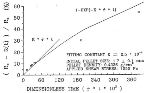
Figure 142 : Influence du temps sur l'érosion d'agregats de noir de carbone [Rwei et al. (1991)]
