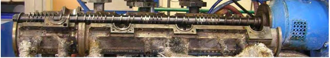
Figure 14 : Photo du co-malaxeur Buss –configuration 15D
