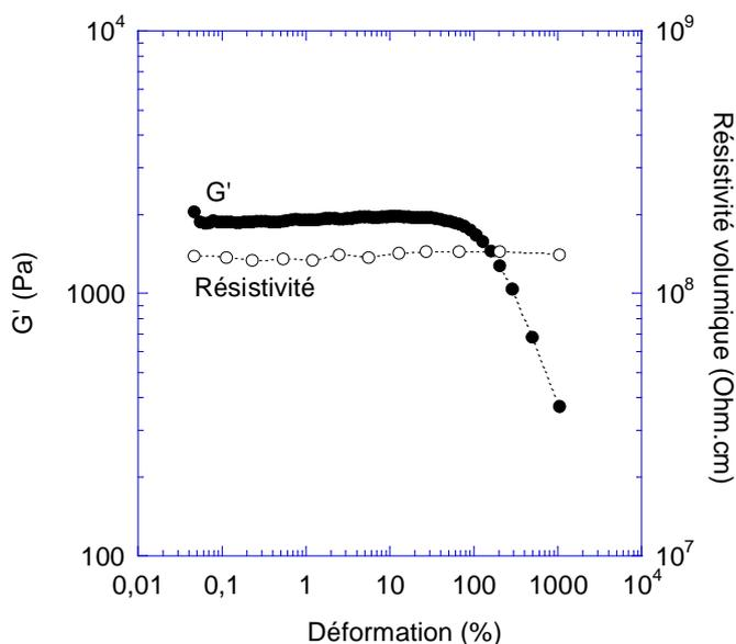
Figure 38 : Mesures électrique et rhéologique simultanées de la matrice Pa/Péba<sup>x</sup>®.
