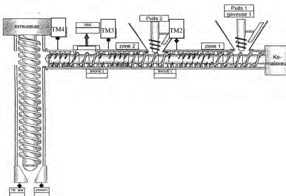
Figure 22 : Points de relevés des paramètres de fonctionnement du Buss en configuration 11D
