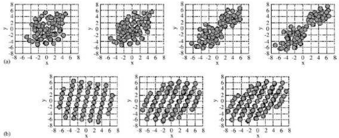
Figure 154 : Projection dans le plan xy de la configuration de l'agglomérat pour différentes valeurs de  $\dot{\gamma}t$ . a) 0 ;  $0,16 \cdot 10^{-4}$  ;  $0,6 \cdot 10^{-4}$  ;  $1 \cdot 10^{-4}$  - configuration aléatoire, b) 0 ;  $0,3 \cdot 10^{-4}$  ;  $0,4 \cdot 10^{-4}$  - configuration cubic simple
