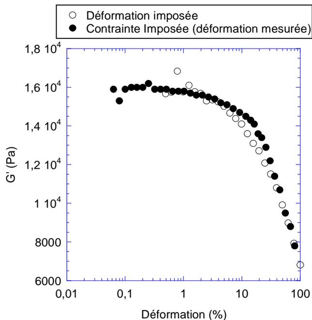
Figure 36 : Valeur du module élastique mesuré avec deux rhéomètres différents : RMS 800 (à déformation imposée), Stresstech (à contrainte imposée et à déformation mesurée). Produit chargé avec 14% NC, fabriqué avec le mélangeur interne dans les conditions standard (240°C, 100 tr/min, 4 min)
