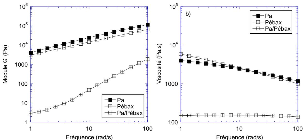
Figure 8 : Evolution du module élastique et de la viscosité en fonction de la fréquence pour le polyamide, le Pébox<sup>®</sup> et le mélange PA/Pébox<sup>®</sup> à 240°C
