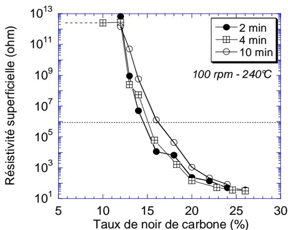
Figure 45 : Influence du temps de mélange sur la courbe de percolation. Paramètres des essais : 240 °C, 100 tr/min et trois temps de mélange : 2 min, 4 min, 10 min.
