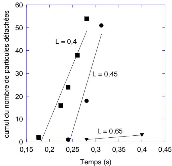
Figure 175 : Evolution du nombre de particules érodées en fonction du temps pour trois viscosités de contact  $L$  : 0,4 ; 0,45 ; 0,65,  $\eta_s / \eta_f = 25$ ,  $\dot{\gamma} = 30 \text{ s}^{-1}$
