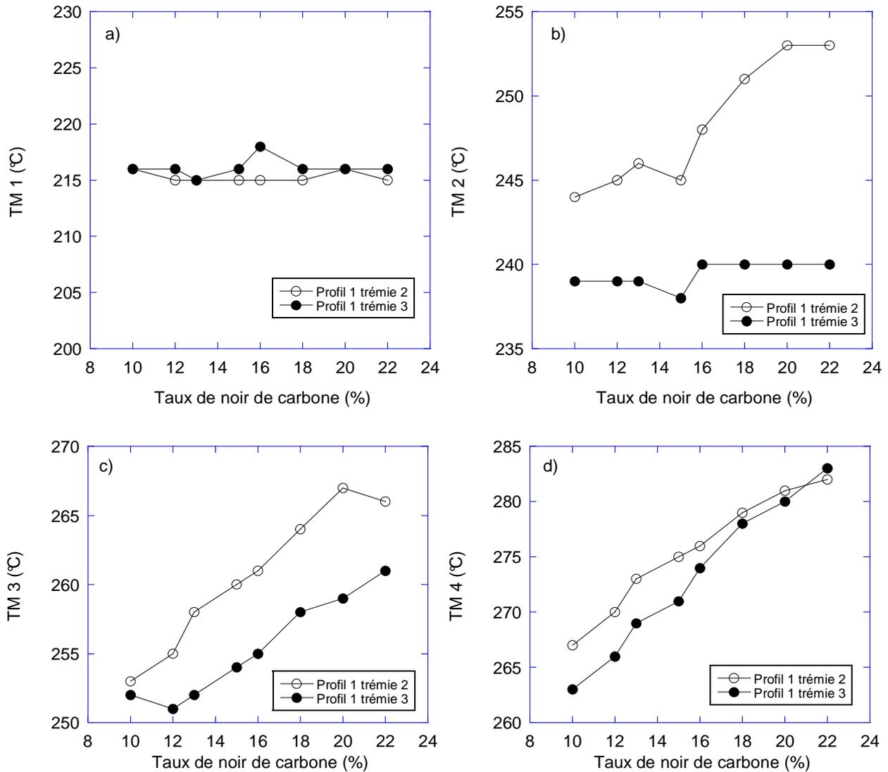
Figure 96 : Evolution de la température en fonction du taux de charges aux points de relevés a) TM1 b) TM2, c) TM3 et d) TM4
