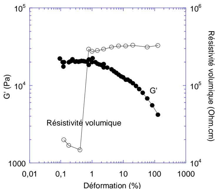
Figure 72 : Mesures rhéologiques et électriques simultanées pour un produit chargé de 18% de noir de carbone et mélangé au mélangeur interne à 100 tr/min, 240°C et 4min.
