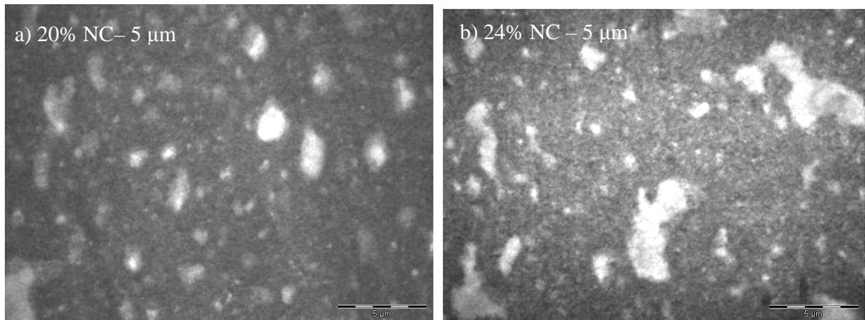
Figure 51 : Images MET de mélanges PA/PébaX<sup>®</sup> chargés à différents taux de noir de carbone a)20% et b)24%. Produits mélangés au mélangeur interne à 240°C, 50 tr/min et 4 min. Grossissement :×4400 – échelle 5 microns.
