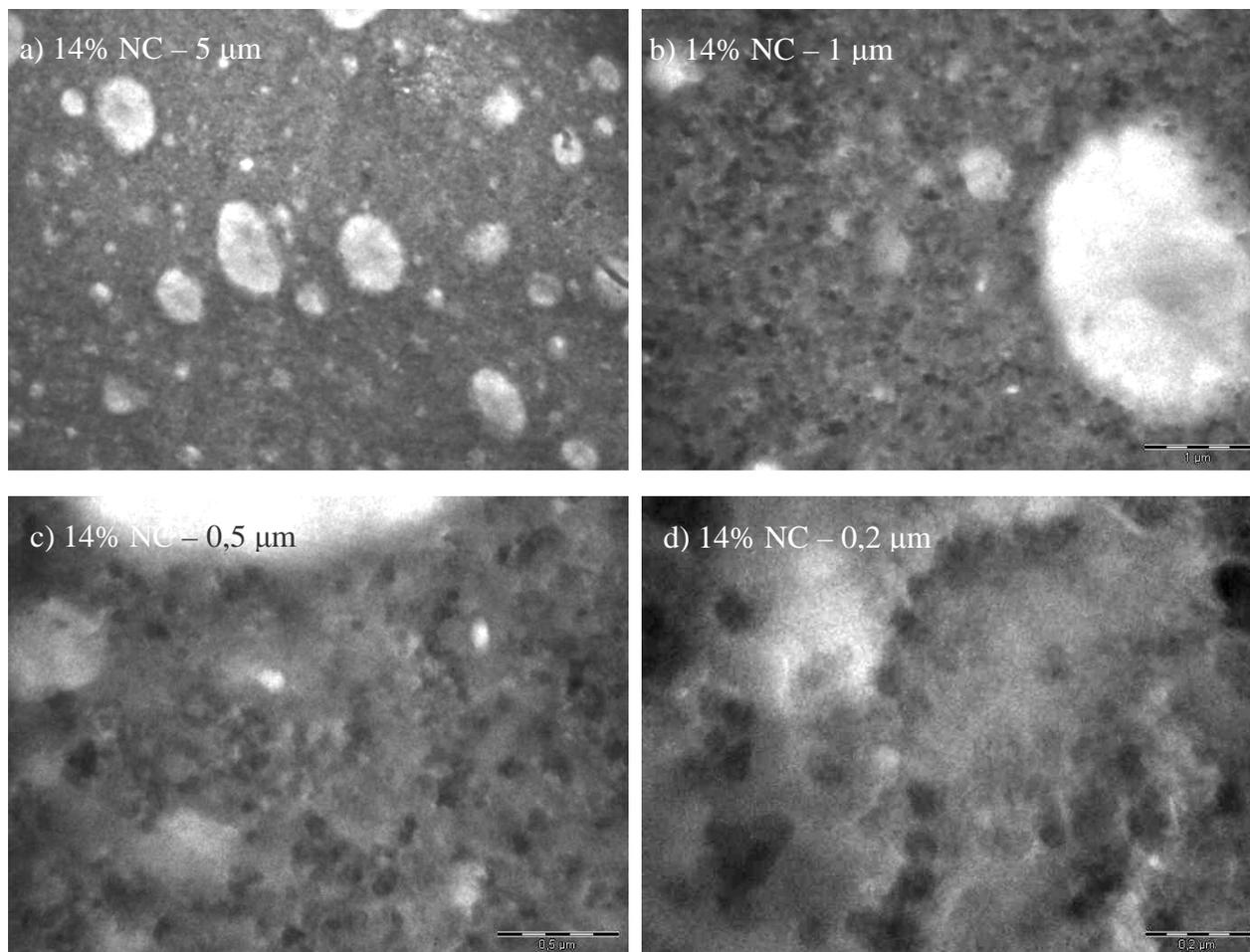
Figure 48 : Images MET d'un mélange PA/Pébox<sup>®</sup> chargé à 14% de noir de carbone a) x 4400, b) x 19500, c) x 40000, d) x 80 000, Produits mélangés au mélangeur interne à 240°C, 50 tr/min et 4 min. Les échelles correspondantes sont respectivement : 5, 1, 0,5 et 0,2 microns.
