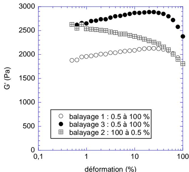
Figure 60 : Evolution du module  $G'$  de la matrice PA/Pébox<sup>®</sup>, au cours de trois balayages successifs en déformation
