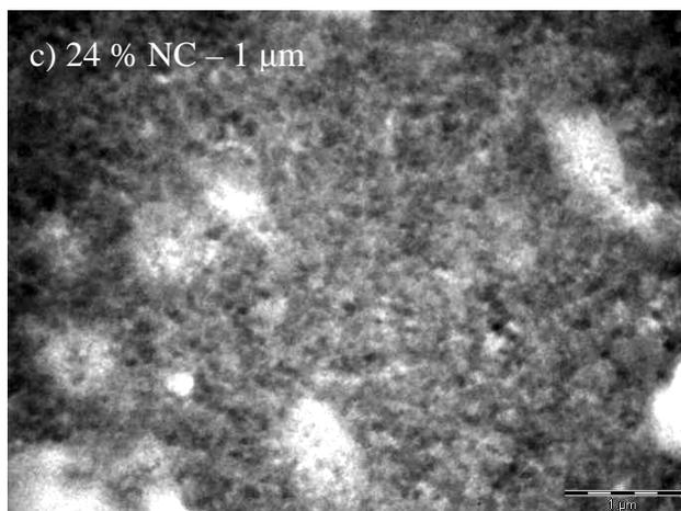
Figure 52 : Images MET de mélanges PA/PébaX<sup>®</sup> chargés à différents taux de noir de carbone a) 12%, b) 16%, c) 24%. Produits mélangés au mélangeur interne à 240°C, 50 tr/min et 4 min. Grossissement : x 19500 – échelle : 1 micron.
