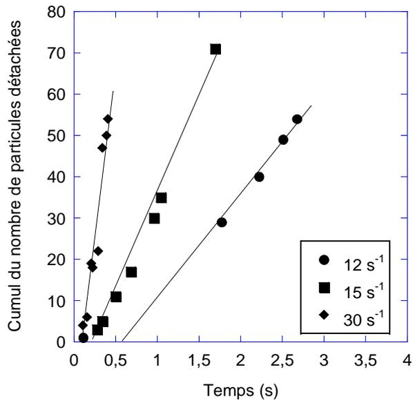
Figure 182 : Effet du taux de cisaillement sur la cinétique d'érosion en fonction du temps.
