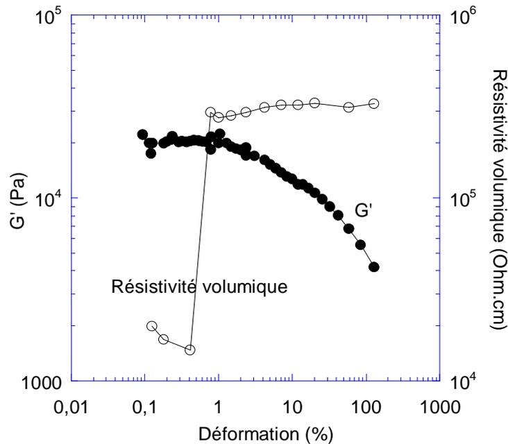
Figure 35 : Exemple de résultat obtenu lors de mesures rhéologiques et électriques couplées. Produit chargé de 18% de NC
