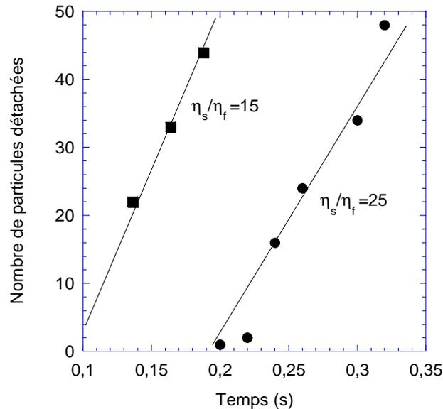
Figure 163 : Evolution du nombre de particules détachées en fonction du temps, pour différentes valeurs de  $\eta_s/\eta_f$  : 5, 15, 25. Simulations réalisées avec un agglomérat constitué de 74 particules, soumis à un écoulement de cisaillement.  $\dot{\gamma} = 30s^{-1}$ .  $R_p=0,009$  mm,  $R_i=0,012$  mm, rayon de l'agglomérat : 0,2 mm
