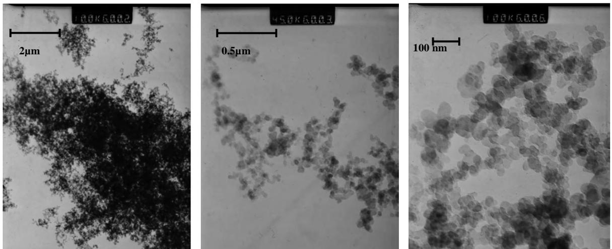
Figure 11 : Images MET de noir de carbone Ensaco 250
