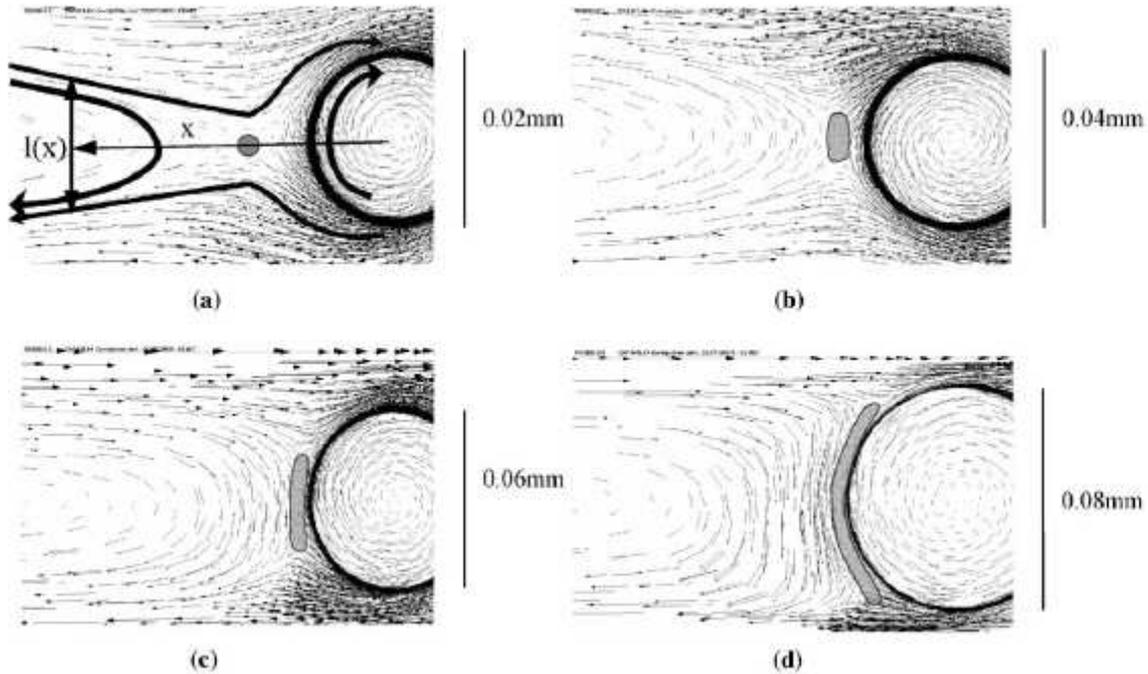
Figure 157 : Simulation d'une particule dans un écoulement de cisaillement. Hauteur de l'écoulement : 0.1 mm, vitesse imposée aux parois : 0.25 mm/s, taux de cisaillement  $5 \text{ s}^{-1}$  Visualisation du champ de vitesse et de la zone de contrainte maximale. Quatre rapports diamètre/hauteur de l'écoulement sont testés : a) 0,2 b) 0,4 c) 0,6 et d) 0,8 [Bikard et al. (2006)]
