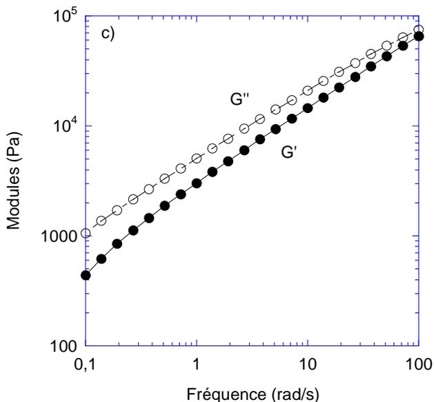
Figure 7 : Etude rhéologique de la matrice Polyamide/Pébox<sup>®</sup>. Essais réalisés à 240°C. a) stabilité thermique. Déformation=8% Temps=1000s b) balayage en déformation de 0,5 à 100 % c) balayage en fréquence de 100 à 0,1 rad/s, déformation 8%
