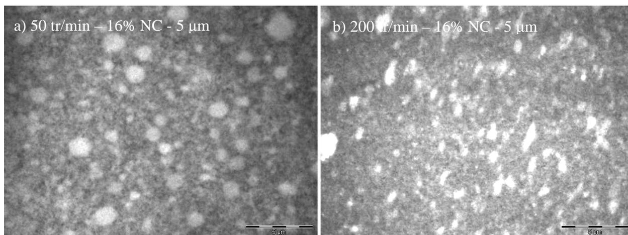
Figure 53: Images MET de mélanges PA/Pébox<sup>®</sup> chargés de 16% de noir de carbone. Produits mélangés au mélangeur interne à 240°C, 4 min et deux vitesses : a) 50 tr/min et b) 200 tr/min. Grossissement :  $\times 4400$  – échelle 5 microns
