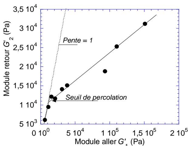
Figure 67 : Evolution de  $G'_2$  en fonction de  $G'_1$  pour une gamme de produits chargés de 10 à 26 % en masse de noir de carbone et mélangés dans les conditions de référence (100 tr/min, 240°C, 4 min)
