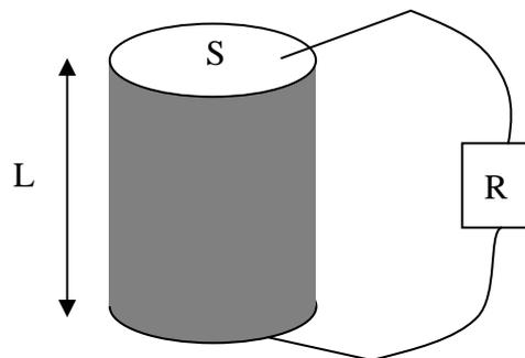
Figure 25 : Mesure de résistivité volumique
