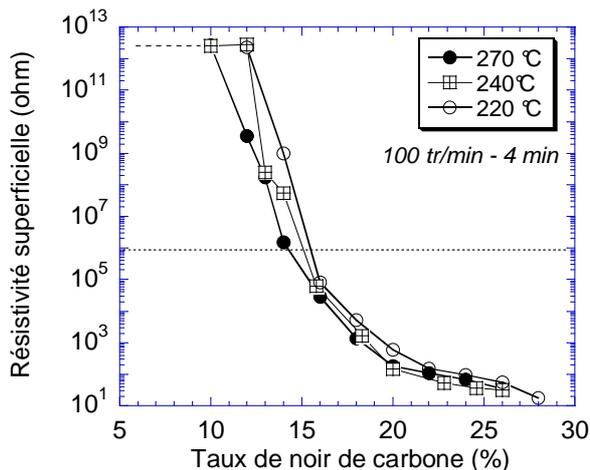
Figure 41 : Influence de la température de consigne sur la courbe de percolation. Paramètres des essais : 100 tr/min, 4min, rotors roller. Températures de consigne : 220°C, 240°C, 270°C.
