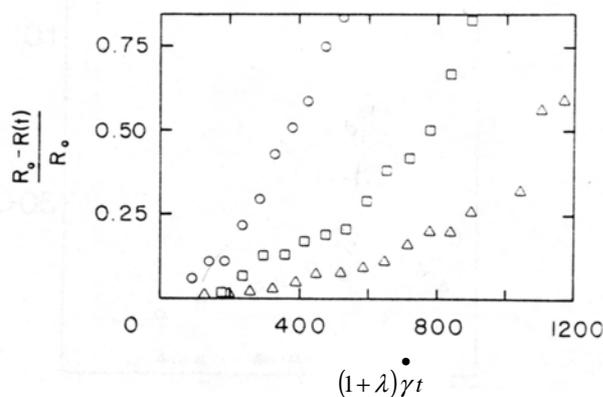
Figure 141 : Effet de la variation du rapport : rayon des agrégats  $a$  sur rayon initial de l'agglomérat  $R_0$ , sur le procédé de dispersion en cisaillement simple ( $\lambda=0$ ). La fraction volumique d'agrégats et les conditions d'écoulement sont fixés. Les symboles correspondent aux valeurs de  $a/R_0$  suivantes : ( $\circ$ )  $a/R_0=0.0275$ , ( $\square$ )  $a/R_0=0.02$ , ( $\triangle$ )  $a/R_0=0.0165$ . (Powell et Mason, 1982)
