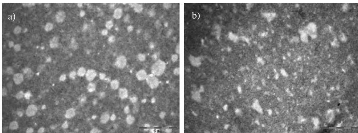
Figure 110 : Mélanges chargés de a) 12% de NC, b) 22% de NC. Produits mélangés au co-malaxeur Buss-Profil 1- Conditions standard : 250°C-230°C-210°C, 280 tr/min, 20 kg/h,  $\rho=10^3\Omega$ . Introduction des charges dans la trémie 3. Grossissement x4400 – Echelle 5 microns
