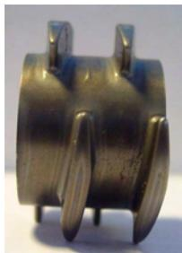
Figure 17 : Élément de mélange KE
