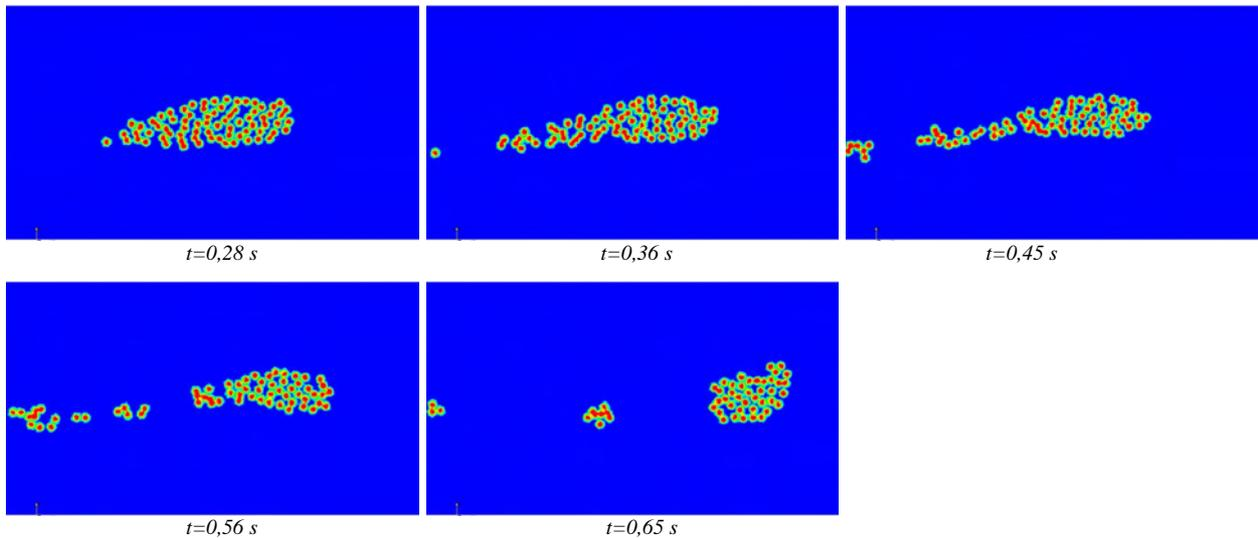
Figure 177 : Comportement d'un agglomérat de 74 particules.  $L = 0,53$  ;  $E = 0,009 \text{ mm}$  ;  $\eta_s / \eta_f = 25$ ,
