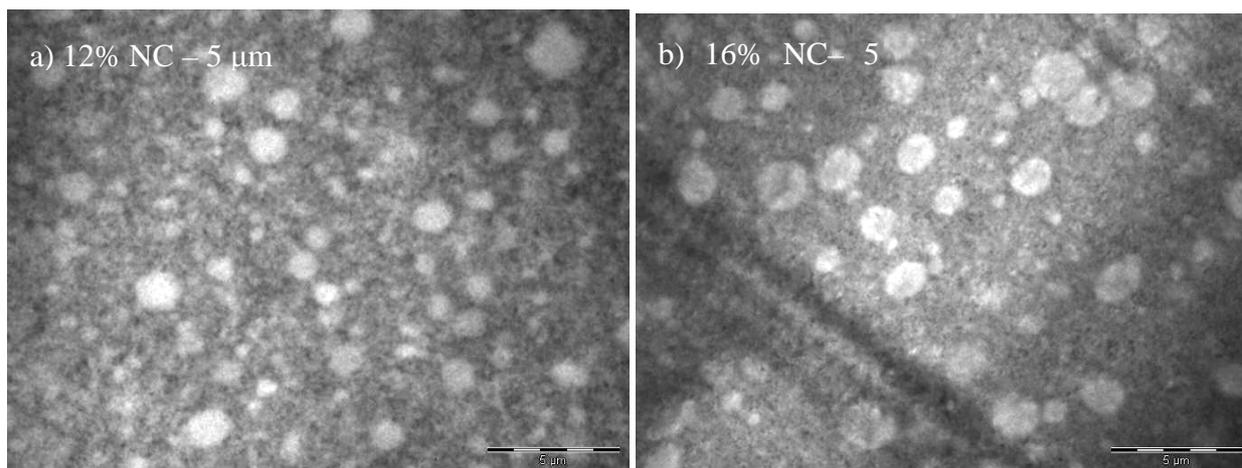
Figure 50 : Images MET de mélanges PA/Pébax<sup>®</sup> chargés à différents taux de noir de carbone a) 12%, b) 16%. Produits mélangés au mélangeur interne à 240°C, 50 tr/min et 4 min. Grossissement : x 4400, échelle : 5 microns.
