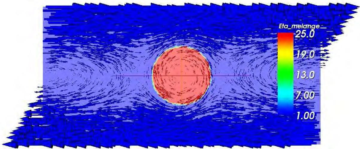
Figure 156 : Particule soumise à un écoulement de cisaillement
