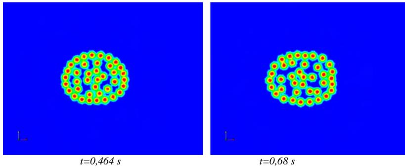
Figure 158 : Dispersion d'un agglomérat constitué d'un arrangement régulier de 39 particules sphériques
